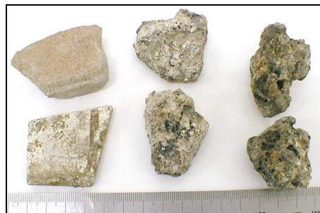
Figura IV-11. Fragments ceràmics a l'esquerra, material de fusió a la dreta i, al centre, partícules mixtes de transició entre un tipus i l'altre. Les partícules tenen entre 25 mm i 40 mm i provenen de la mostra de Mataró recollida el novembre del 2001.
