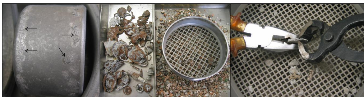
Figura IV-46. Esquerra, partícules metàl·liques adherides a la superfície d'una de les peces del molí d'anelles a causa de l'escalfament per a la trituració. Centre, fracció 16/20 de Girona, tamís 10 mm UNE. Dreta, reducció manual de la mida de partícula de partícules metàl·liques de les escòries de Sant Adrià, tamís 4 mm UNE.
