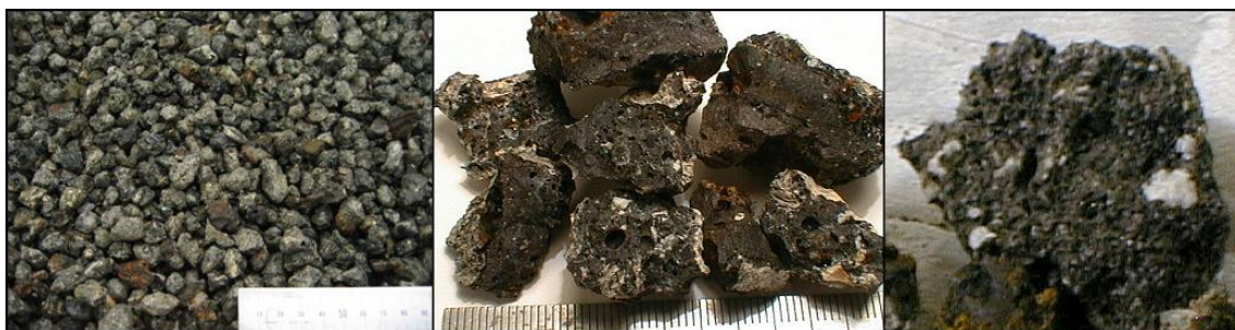
Figura IV-18. Productes de fusió: esquerra, partícules de la fracció 10-20 mm de Tarragona, març del 2001. Centre i dreta, partícules de Mataró, gener del 2001, de mida original >22.4 mm però fragmentades per observar l'aspecte interior.
