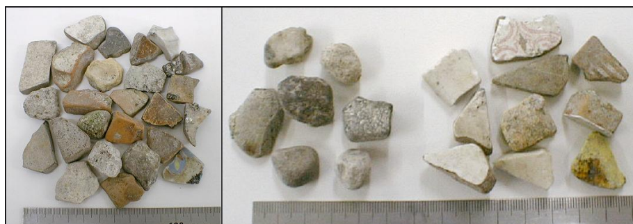
Figura IV-8. Partícules incloses dins la denominació de material ceràmic i àrids. Esquerra: fracció 20-40 mm de la mostra de Tarragona (gener del 2001), es poden observar materials d'origen divers. Dreta: partícules corresponents a la fracció 16-20 mm de les escòries de Tarragona (març del 2001), separant àrids i fragments ceràmics.
