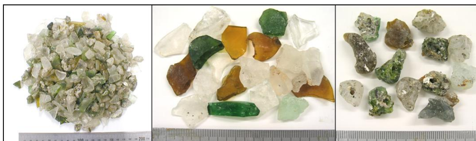
Figura IV-5. Aspecte de les partícules de vidre. La imatge de l'esquerra correspon al vidre de la fracció 10-12.5 mm de la mostra de Mataró del gener del 2001. Al centre i la dreta es presenten algunes partícules corresponents a la fracció 12.5-16 mm de les escòries de Tarragona del gener del 2001, que mostren les dues morfologies que adopta el vidre.
