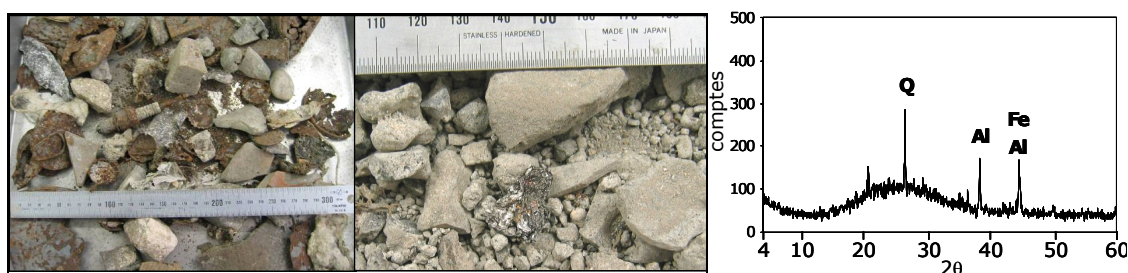
Figura IV-70. A l'esquerra, aspecte de la fracció >20 mm de les escòries de Malla, i al centre, paper d'alumini a les escòries de Tarragona del març. A la dreta, espectre de DRX corresponent a la fracció de 16 mm a 20 mm de Girona.
