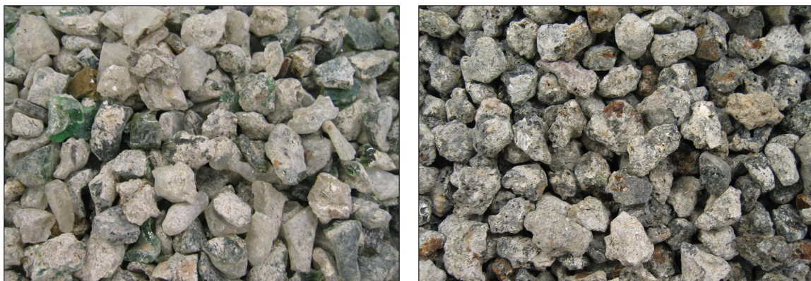
Figura V-4. Aspecte del vidre domèstic (esquerra) i dels productes de fusió (dreta) de les escòries de Tarragona, corresponents a la fracció granulomètrica 12.5/20, per mostrar l'angulositat de les partícules d'aquests constituents, que són les majoritàries a les escòries.
