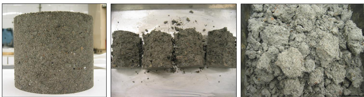
Figura V-15. Probeta de Proctor compactada (esquerra), que s'obre al llarg en 4 parts per extreure mostra representativa (centre) i assecar-la durant 24 hores per determinar la humitat (dreta). Un cop secs, els agregats no es desfan.
