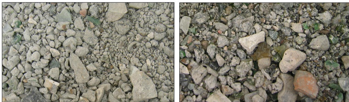
Figura V-9. Aspecte general de la fracció 2/20 de les escòries de Tarragona del juliol abans (esquerra) i després (dreta) d'aplicar el rentat sobre el tamís de 0.5 mm. S'observa que les escòries presenten una fina capa de pols i partícules fines adherides a la superfície.
