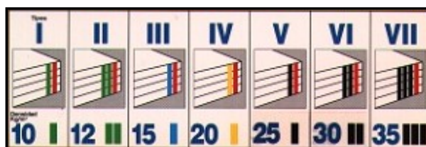
Figura 3.1: Normas de identificación del EPS [ANAPE, 1992]
