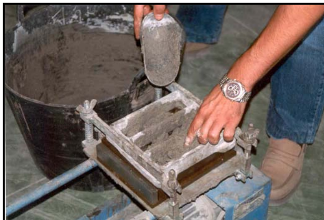
Figura 3.7: Fabricación probetas de mortero 40 x 40 x 160 (mm)
