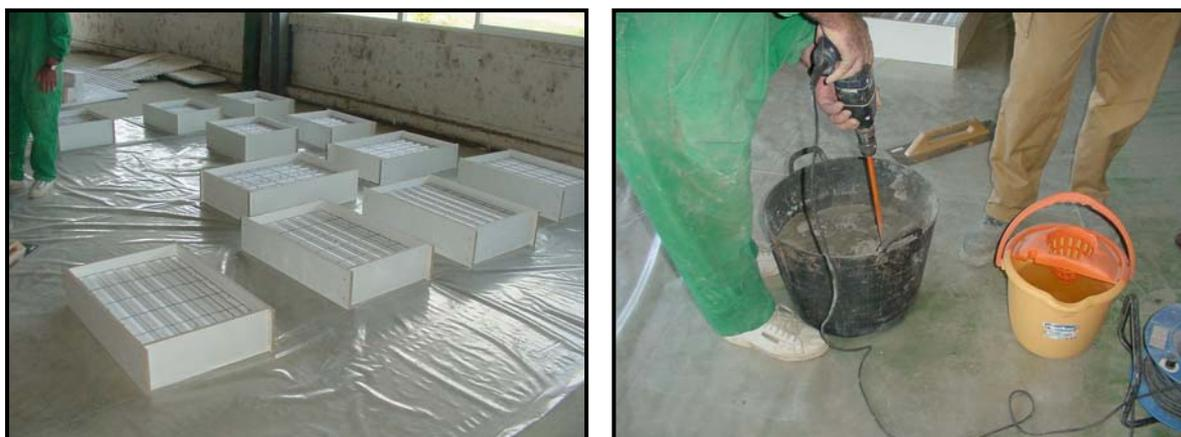
*Figura 4.2: Molde y preparación del mortero – 1ª fase de ensayos*
