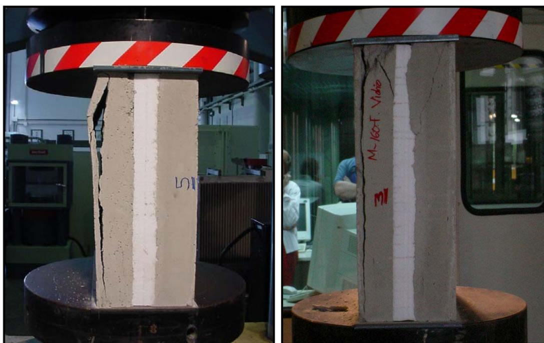
Figura 4.10: Perspectiva de la formación de lajas en la rotura (panel 5)
