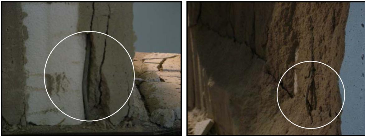
*Figura 4.11: Desprendimiento del mortero por pandeo de la armadura - panel 4, carga de rotura 650 kN*
