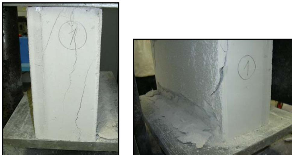
*Figura 4.16: Rotura sobre el panel 1*
