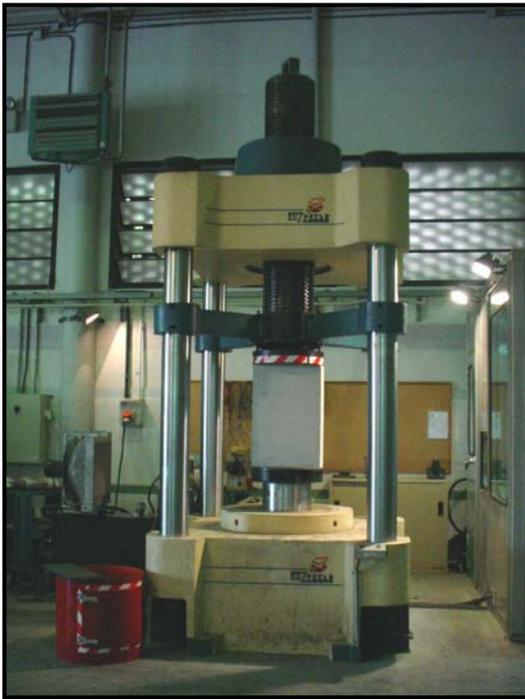
*Figura 4.4: Prensa de carga utilizada en el ensayo – Capacidad 500 t*
