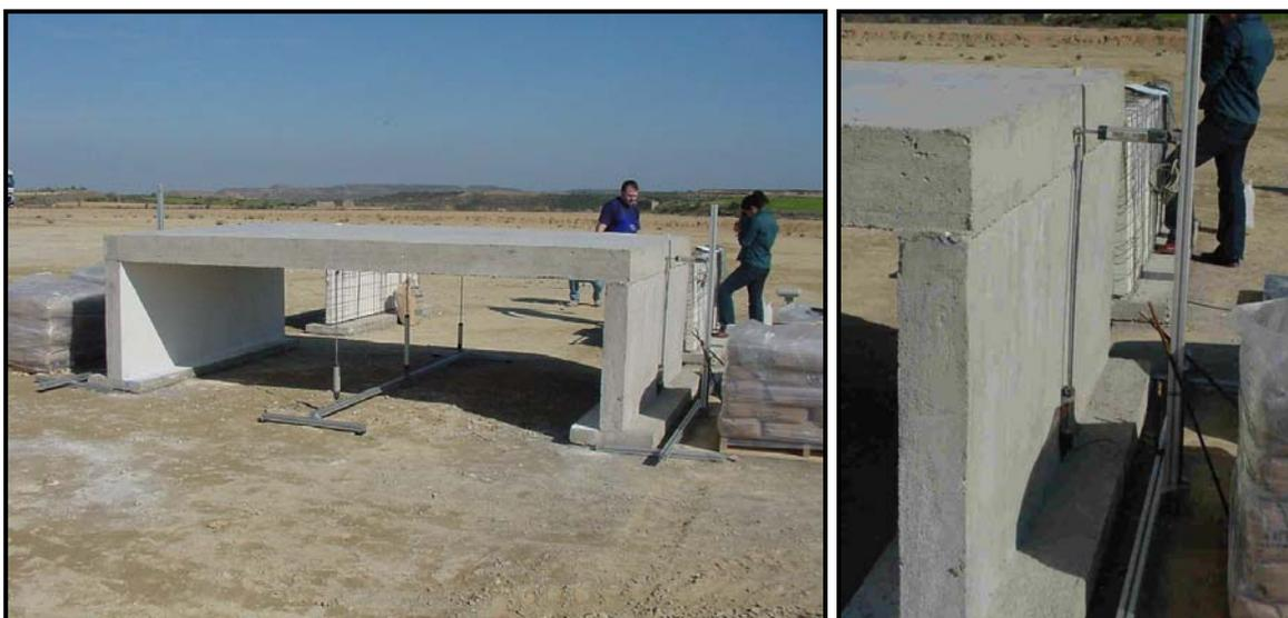
*Figura 6.2: Vista general del ensayo y detalle de uno de los transductores horizontales ubicado en un extremo de la losa*
