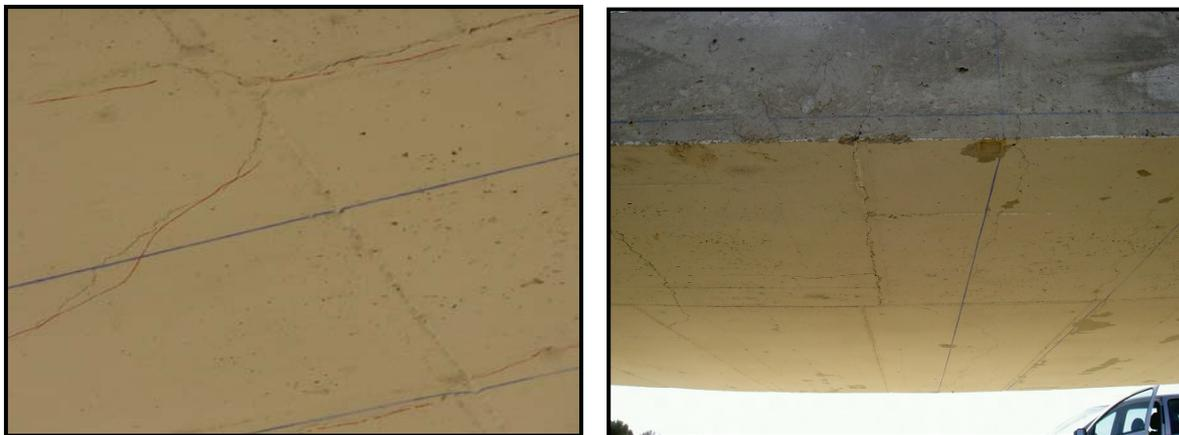
*Figura 6.27: Diversas fisuras para estados avanzados de carga*
