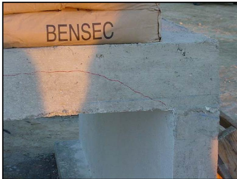
Figura 6.28: Fisuración por cortante en el canto de la zona del apoyo C
