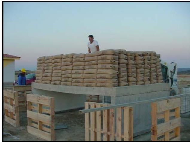
Figura 6.16: Distribución de carga para la 8ª hilada, mantenida durante 20 horas
