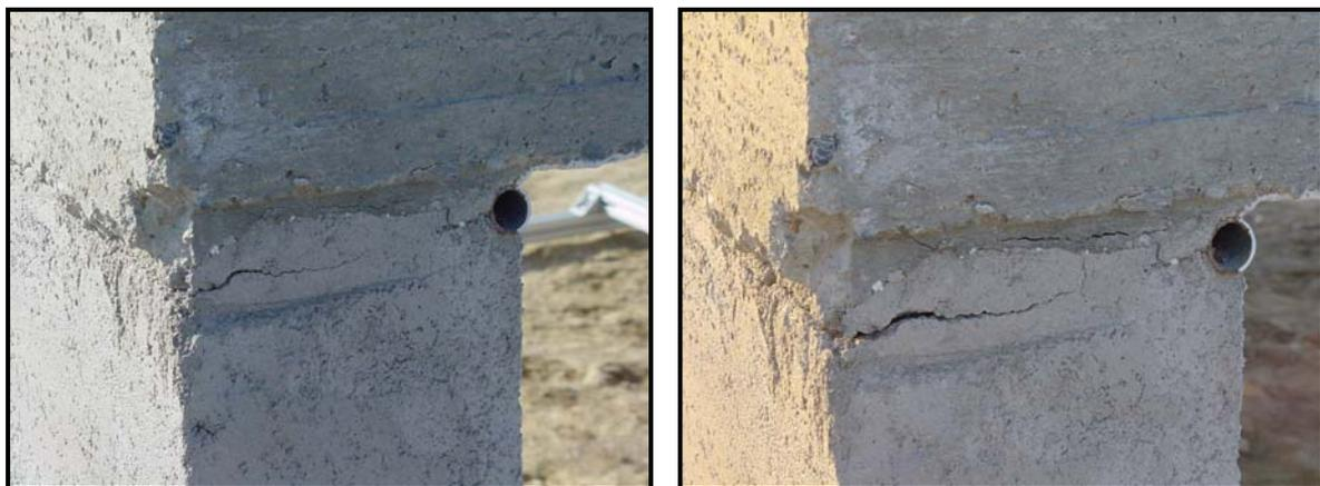
*Figura 6.31: Apertura de junta en el apoyo A para el 2º y 6º escalón de carga*
