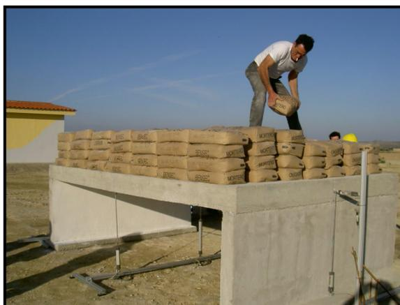
Figura 6.15: Distribución de carga para la 1ª hilada y la carga teórica de rotura
