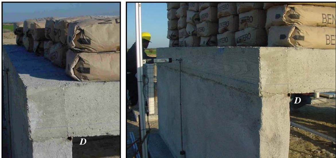
Figura 6.29: Zona apoyo D, para el 2º y 6º escalón de carga. No aparición de fisuras debidas al esfuerzo cortante
