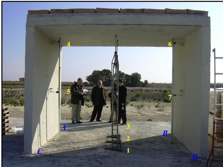
Figura 8.10: Ubicación de los transductores en el pórtico ensayado
