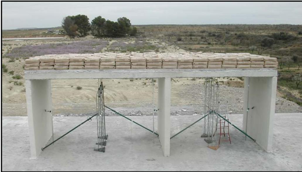
*Figura 8.19: Pórtico Continuo - Carga total.*
