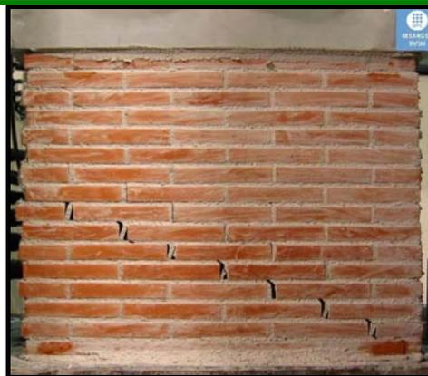
**b) Deslizamiento de Juntas 9V5H**
