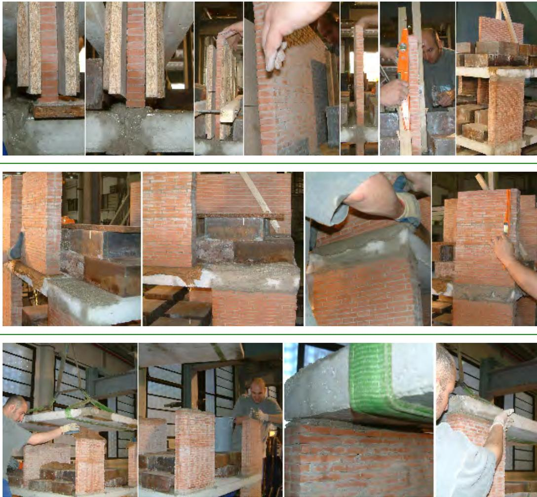
Figura 4. 8 [Proceso constructivo de los modelos con paredes de obra de fábrica de ladrillo]
