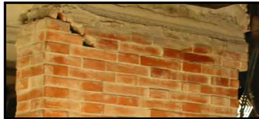
(b) Rotura presentada por el muro M1
