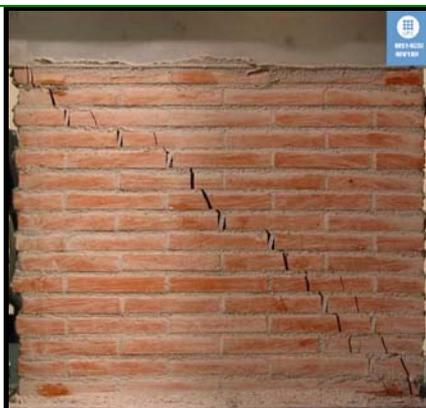
**c) Rotura a tracción de ladrillos 40V18H**
