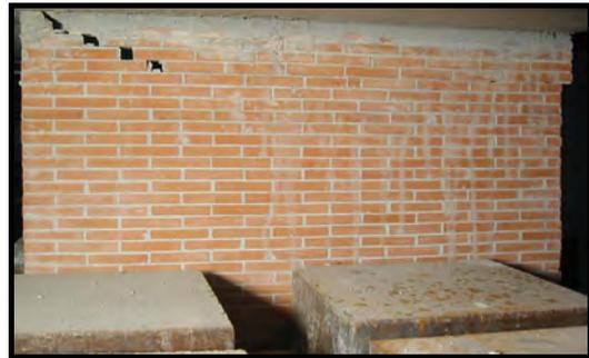
(c) Rotura presentada por el muro M2
