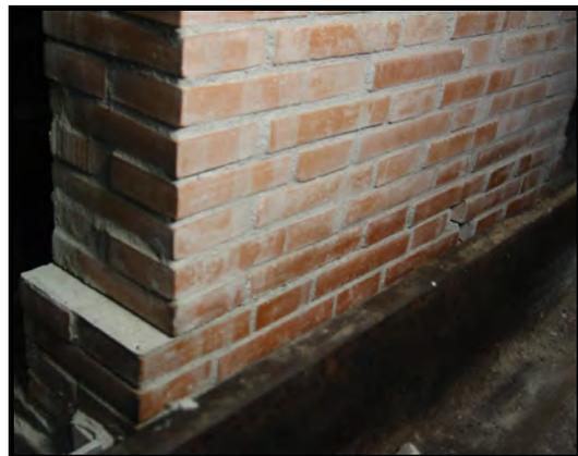
(e) Rotura presentada por el muro M4
