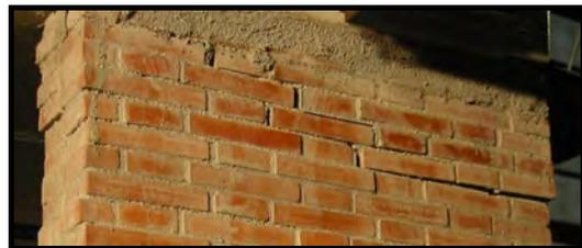
(d) Rotura presentada por el muro M3
