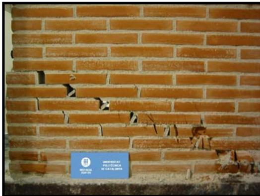
c) Deslizamiento de Juntas 25V12H
