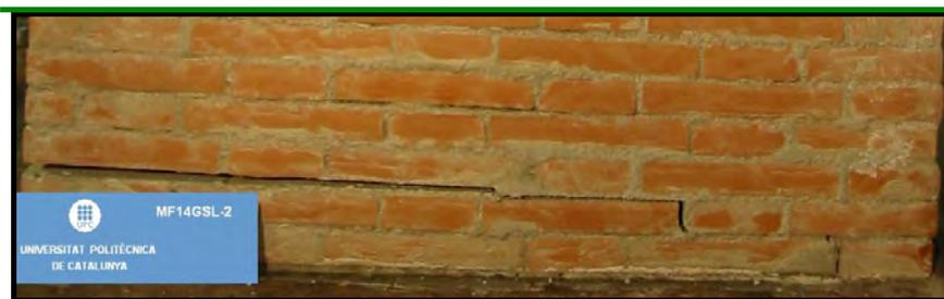
Figura 4. 21 [Mecanismo de rotura los muro MF14GSL-2]
