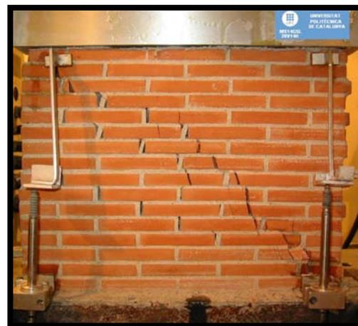
d) Transición entre Deslizamiento de juntas y rotura a tracción de ladrillos 28V14H
