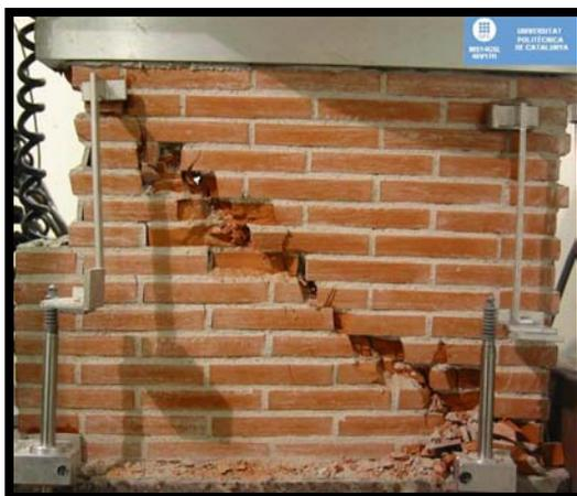
e) Rotura a tracción de ladrillos 40H17V
