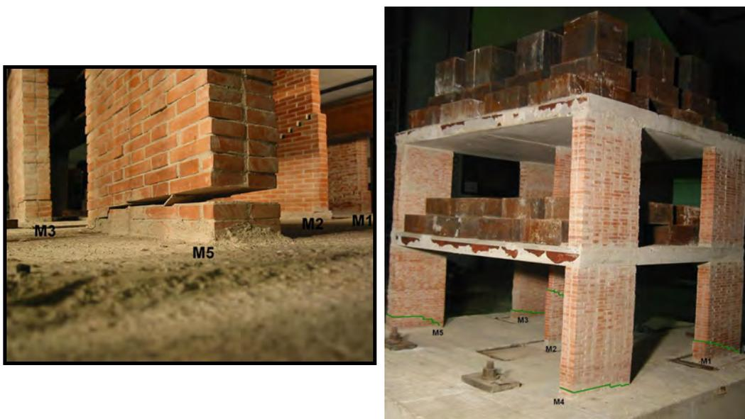
**Figura 4. 35 [rotura presentada en el modelo (VII)]**
