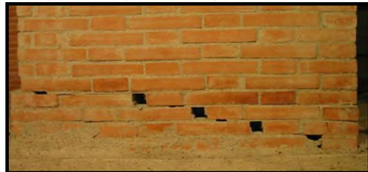
(c) Rotura presentada por el muro M3
