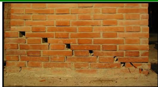
(a) Rotura presentada por el muro M1
