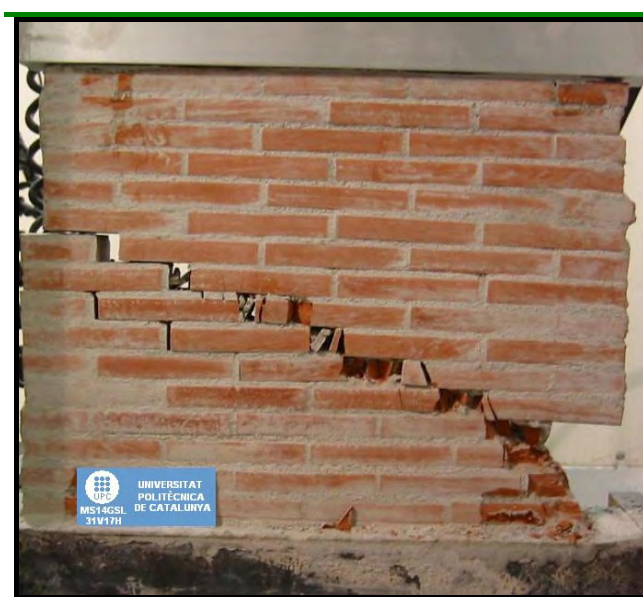
Figura F.103 [Mecanismo de rotura MS14GSL – 31V15H]
