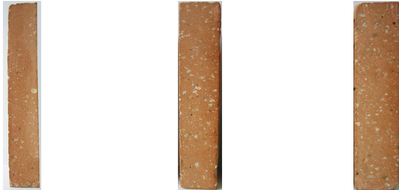
Figura A. 1 [Ladrillos cortados – irregularidad en la testa ]
