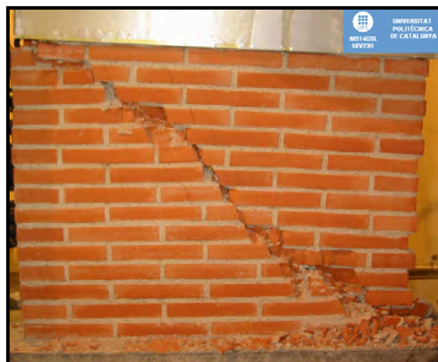
Figura F.118 [Mecanismo de rotura MS14GSL – 56V23H]
