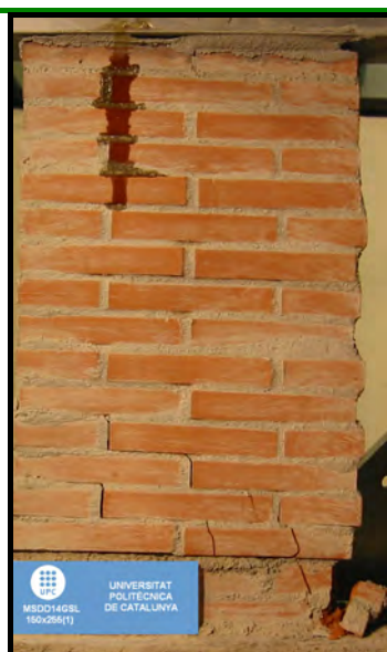
Figura F.125 [Mecanismo de rotura MSDD14GSL – 150x255(1)]
