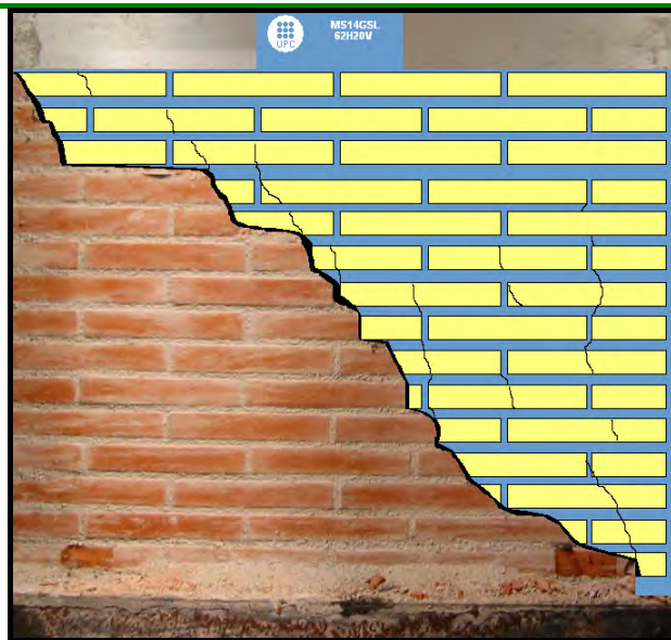
Figura F.121 [Mecanismo de rotura MS14GSL – 62V20H]
