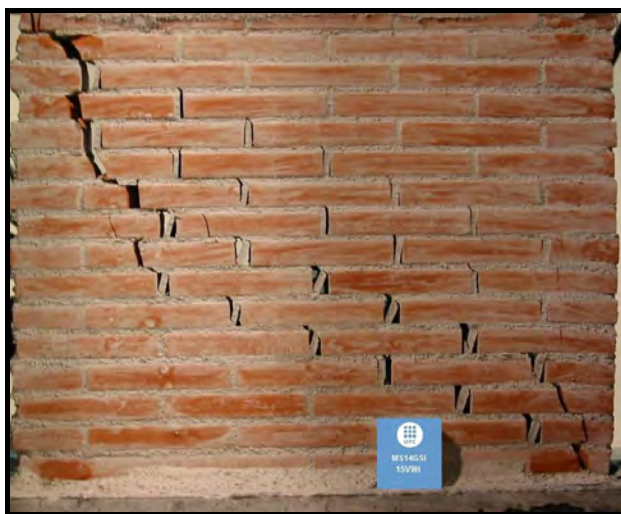
Figura F. 52 [Mecanismo de rotura MS14GSI – 15V9H]
