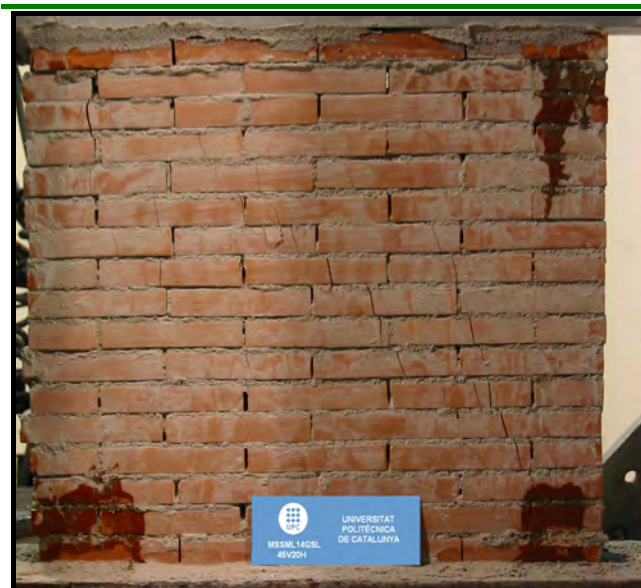
Figura F.155 [Mecanismo de rotura MSSML14GSL – 45V20H]
