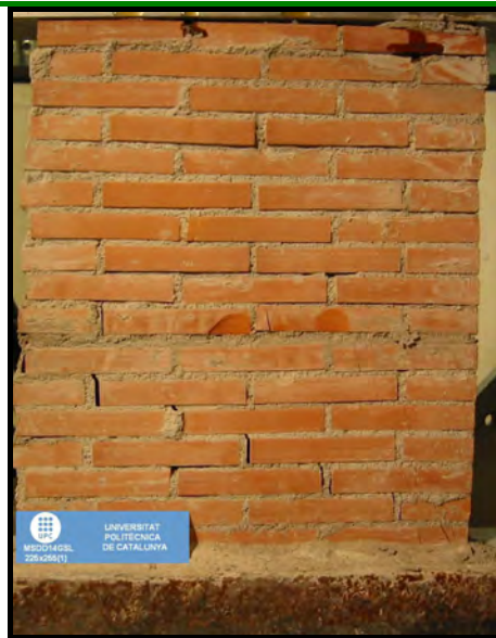
Figura F.129 [Mecanismo de rotura MSDD14GSL – 225x255(1)]
