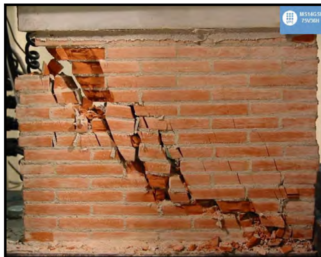
Figura F.76 [Mecanismo de rotura MS14GSI – 75V36H]
