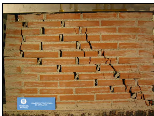
Figura F.137 [Mecanismo de rotura MSDD14GSL – 300x195(1)]
