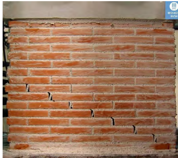
Figura F. 49 [Mecanismo de MS14GSI – 9V5H]
