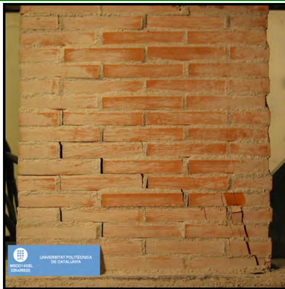
Figura F.131 [Mecanismo de rotura MSDD14GSL – 225x255(2)]
