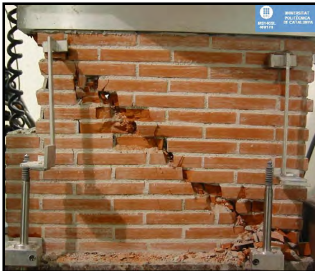
Figura F.109 [Mecanismo de rotura MS14GSL – 40V17H]
