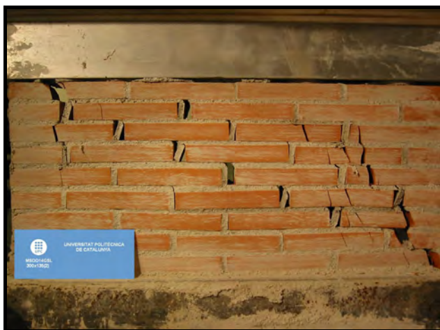
Figura F.135 [Mecanismo de rotura MSDD14GSL – 300x135(2)]
