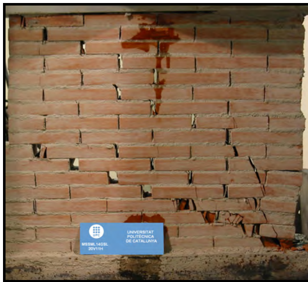
Figura F.146 [Mecanismo de rotura MSSML14GSL – 20V11H]
