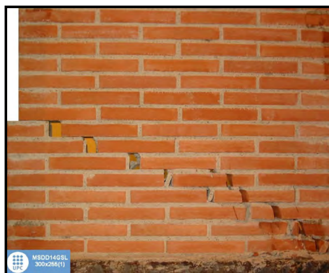
Figura F.141 [Mecanismo de rotura MSDD14GSL – 300x255(1)]
