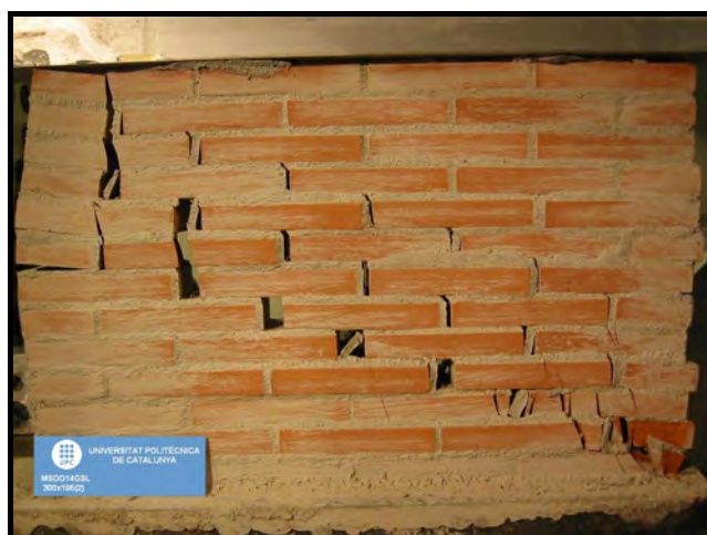
Figura F.139 [Mecanismo de rotura MSDD14GSL – 300x195(2)]
