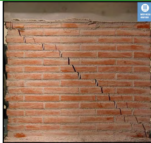
Figura F. 64 [Mecanismo de rotura MS14GSI – 40V18H]
