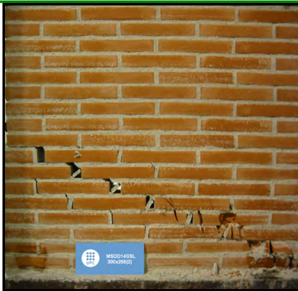
Figura F.143 [Mecanismo de rotura MSDD14GSL – 300x255(2)]
