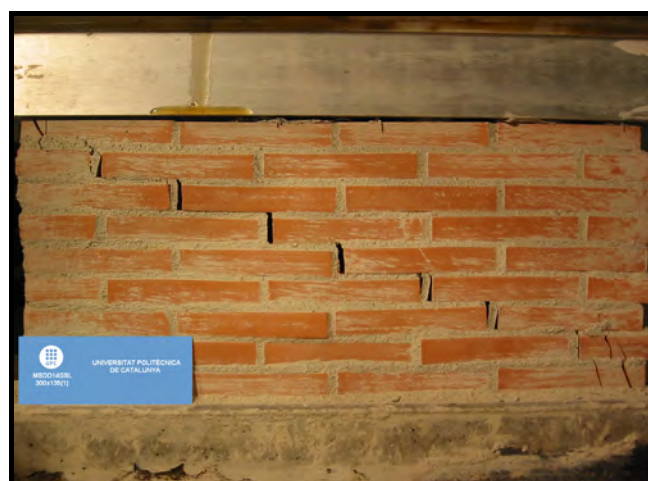
Figura F.133 [Mecanismo de rotura MSDD14GSL – 300x135(1)]
