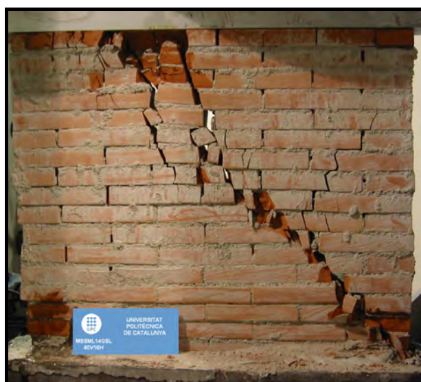
Figura F.152 [Mecanismo de rotura MSSML14GSL – 40V16H]
