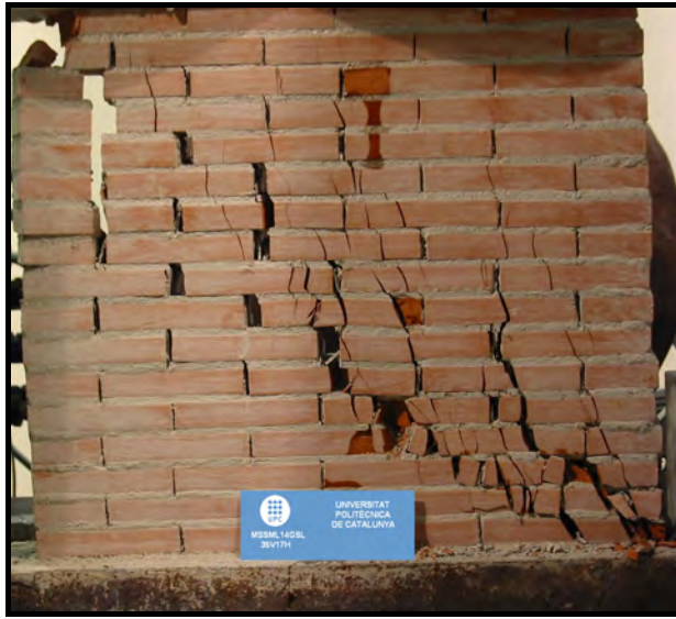
Figura F.149 [Mecanismo de rotura MSSML14GSL – 35V17H]
