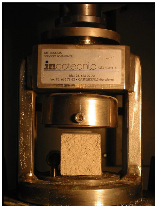
Figura C. 2 [DISPOSITIVOS DE ENSAYO DE RESISTENCIA A COMPRESIÓN DE MORTERO ENDURECIDO
