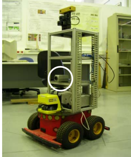
Figura 6.5: Robot mòbil Pioneer 3AT emprat en els experiments, on es veu el posicionament de la càmera.
