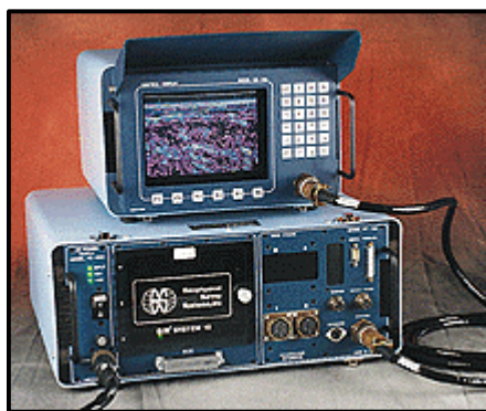
Figura 5.14. Fotografía de la unidad central y del monitor del georradar SIR-10 de “GSSI” (página WEB de “GSSI”: www.geophysics.com ).
