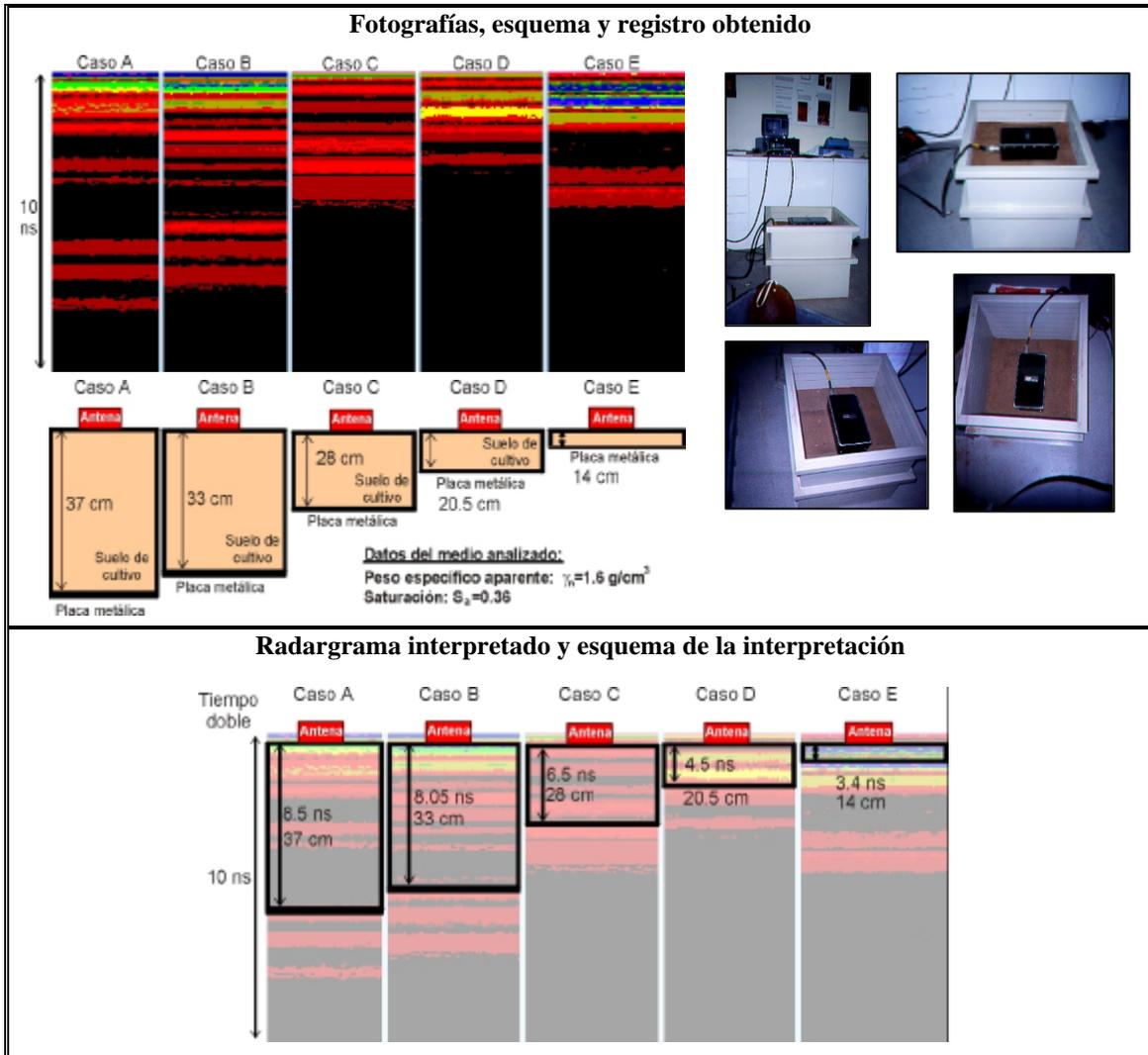
**Información previa:** Profundidad a la lámina: 37 cm (caso A), 33 cm (caso B), 28 cm (caso C), 20.5 cm (caso D) y 14 cm (caso E). Conductividad:  $\sigma=25.1$  mS/m. Peso específico aparente:  $\gamma_n=1.6$  g/cm<sup>3</sup>. Peso específico de la matriz sólida:  $\gamma_s=2.67$  gr/cm<sup>3</sup>. Saturación:  $S_a=0.36$ . Porosidad:  $n=0.46$ . Suelo de cultivo arcilloso.
