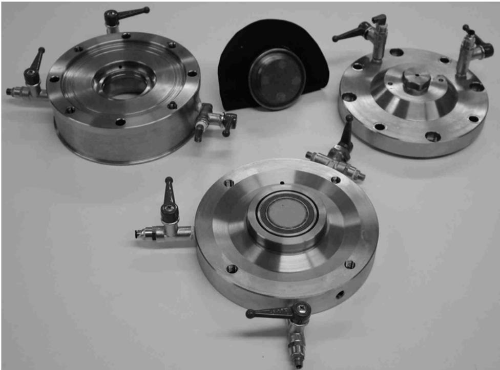
Figura 3.7 Edómetro con control de succión matricial ( $u_a - u_w$ ) y total ( $\Psi$ ).
