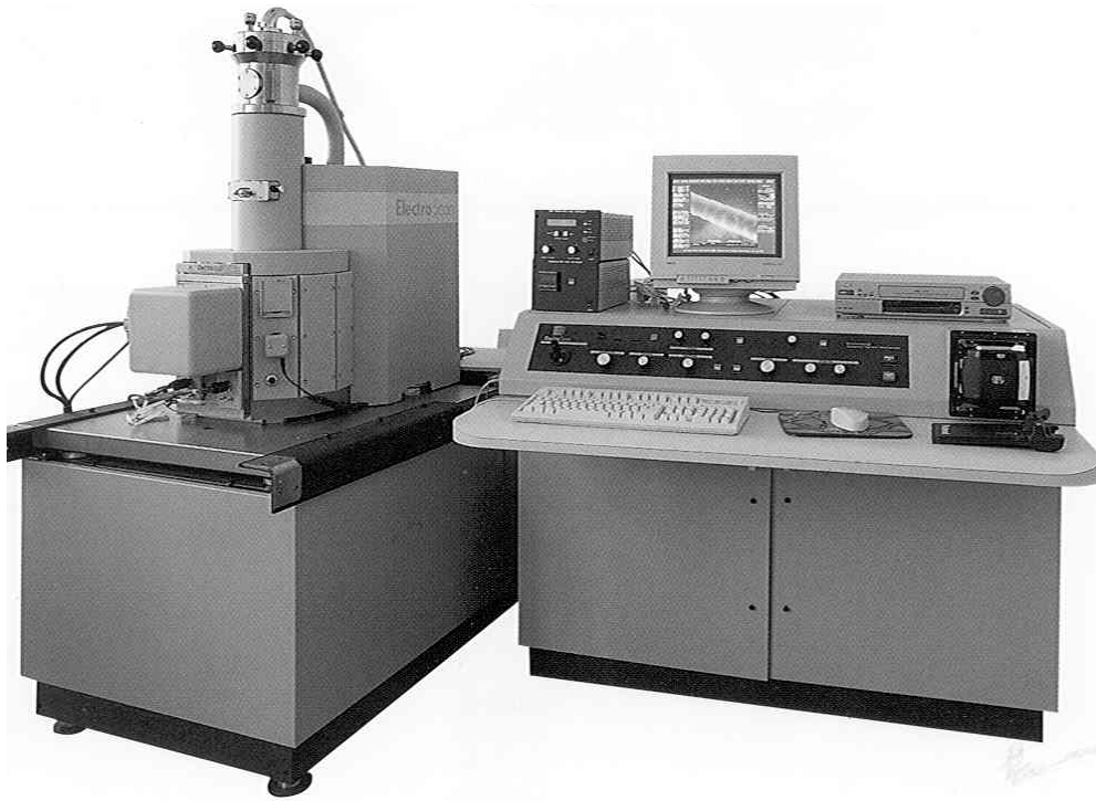
Figura 4.3 Microscopio electrónico de barrido ambiental Electroscan 2020 (ESEM).
