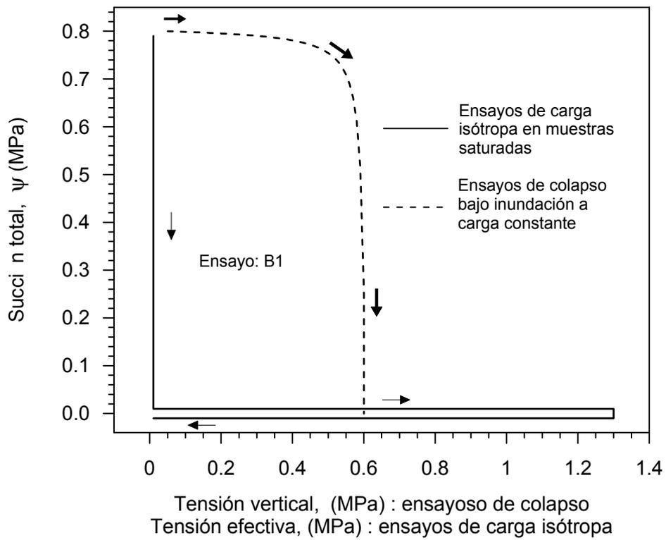
Figura 4.23 Trayectoria de tensión y succión, en los ensayos de carga isotrópica y de colapso bajo inundación a carga constante, (ejemplo ensayo B1).
