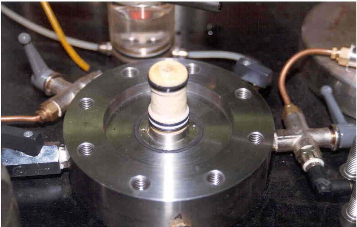
Figura B.2 Cuerpo inferior de la mini-célula isotropa rígida con la muestra montada ( $\phi = 20$  y  $h = 20$  mm).
