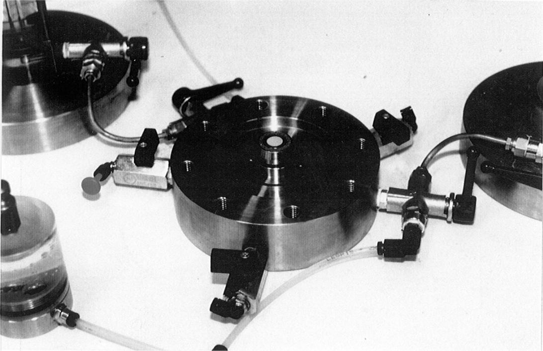
Figura B.1 Cuerpo inferior de la mini-célula isotropa rígida.
