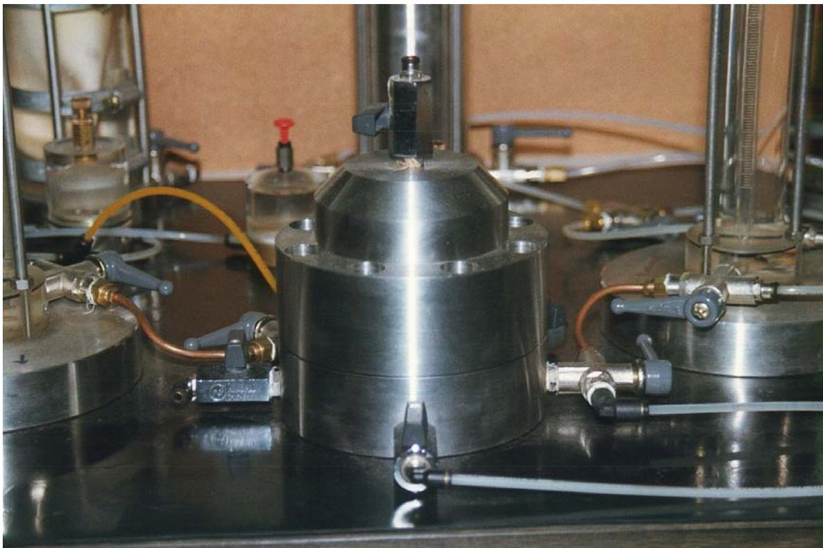
Figura B.4 Mini-célula isotropa rígida con los medidores de volumen.
