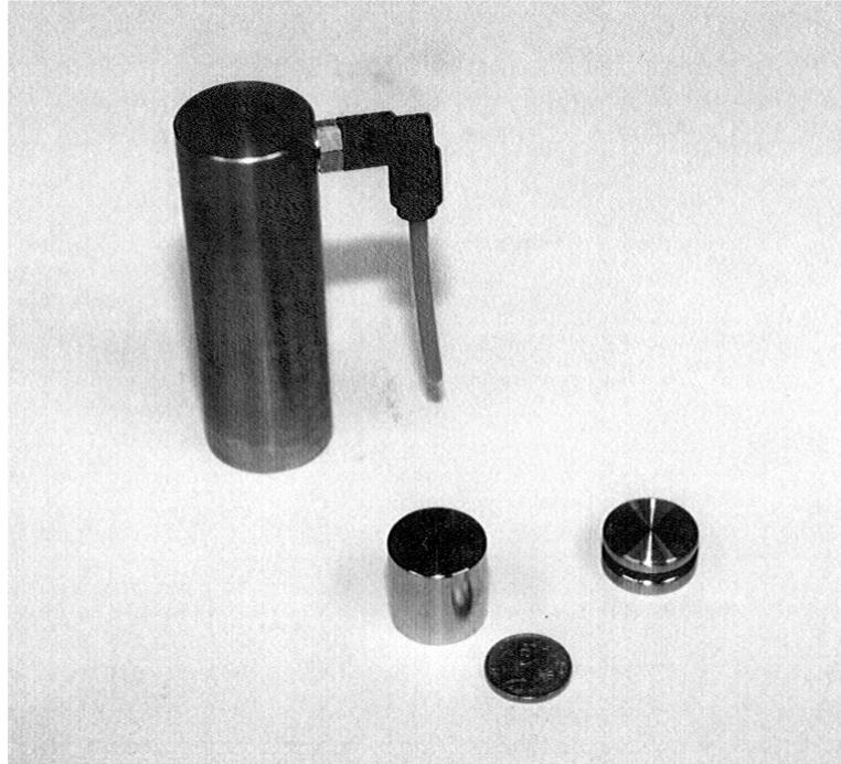
Figura B.3 Accesorios complementario, de izquierda a derecha: acoplador de membranas, cilindro de acero inoxidable para calibraciones (dimensiones de la probeta) y cabezal.
