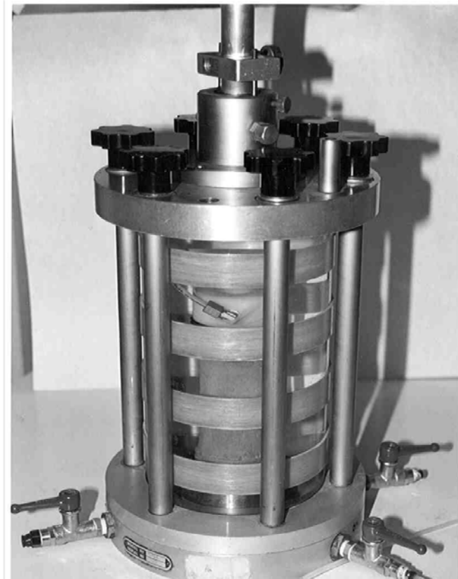
Figura C.1 Compactación estática en condiciones isotropa (tensión controlada), cámara triaxial convencional ( \phi_0=50 mm, h_0= 100 mm).
