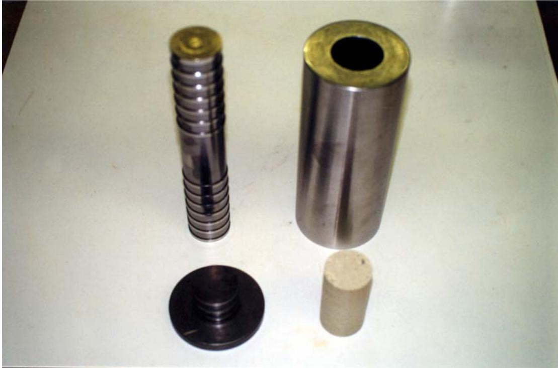
Figura 4.5.1 Muestra y vaso compactador (altura de la muestra de 76 mm y diámetro de 38 mm).
