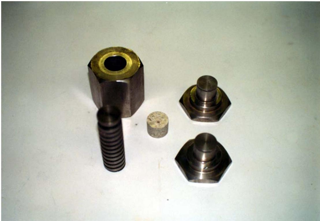
Figura 4.2.3.2 Vaso compactador de muestras de 15 mm de diámetro por 12 mm de altura.
