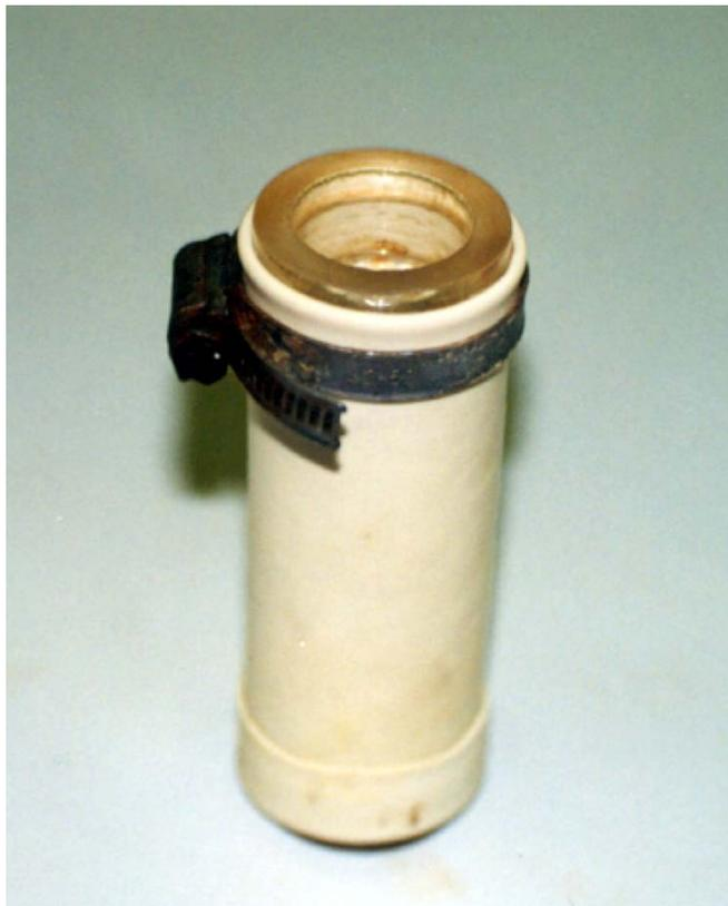
Figura 5.2.1.5 Detalle de las medidas para asegurar la estanqueidad de la muestra en sus extremos. En el extremo opuesto se aísla igual.
