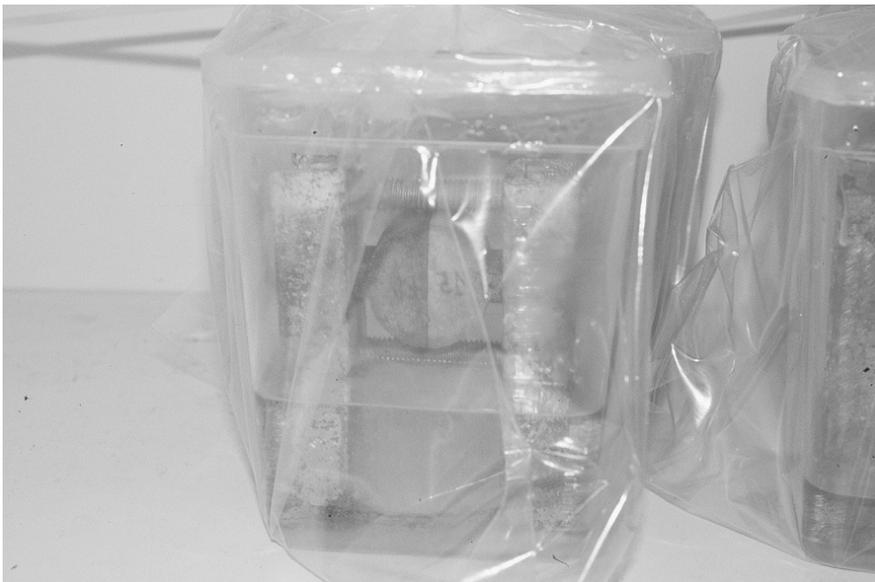
Figura 4.2.3.5 Molde en el interior del recipiente con la disolución
