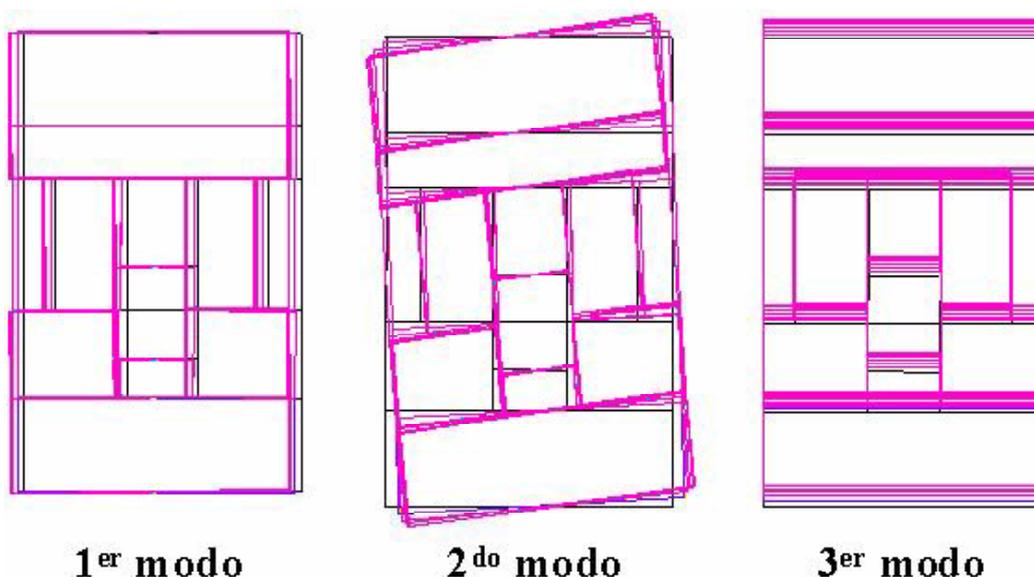
**Figura 11.10.** Los tres primeros modos de vibración del modelo M.3 ( 6 niveles ) (Bonett et al., 2003).
