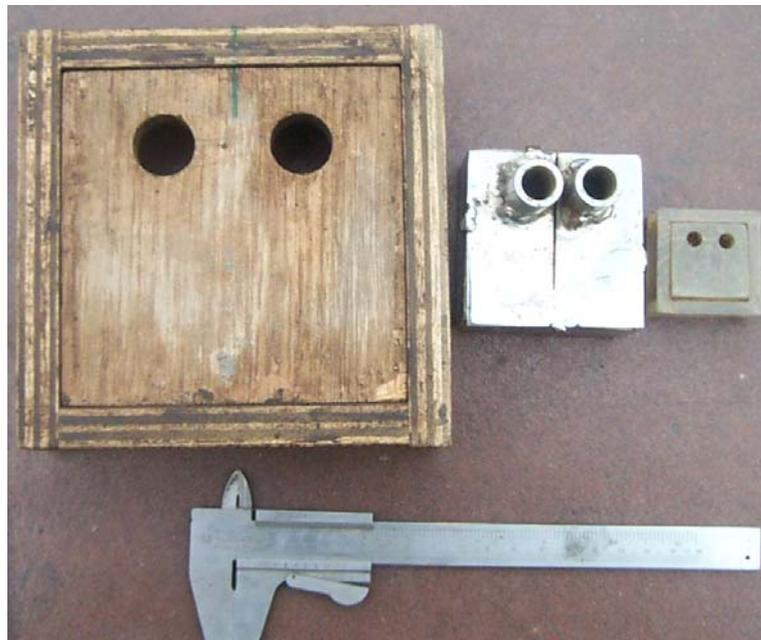
Figura 5.28 Moldes empleados para la fabricación de las muestras geométricamente similares pero de diferentes tamaños.
