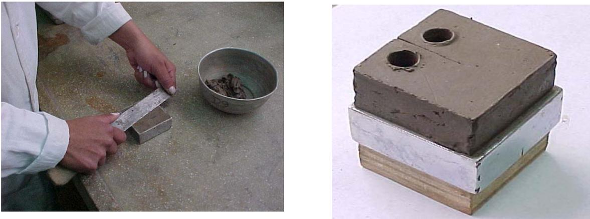
Figura 5.11 Preparación de la muestra y detalle de una muestra recién extraída del molde.
