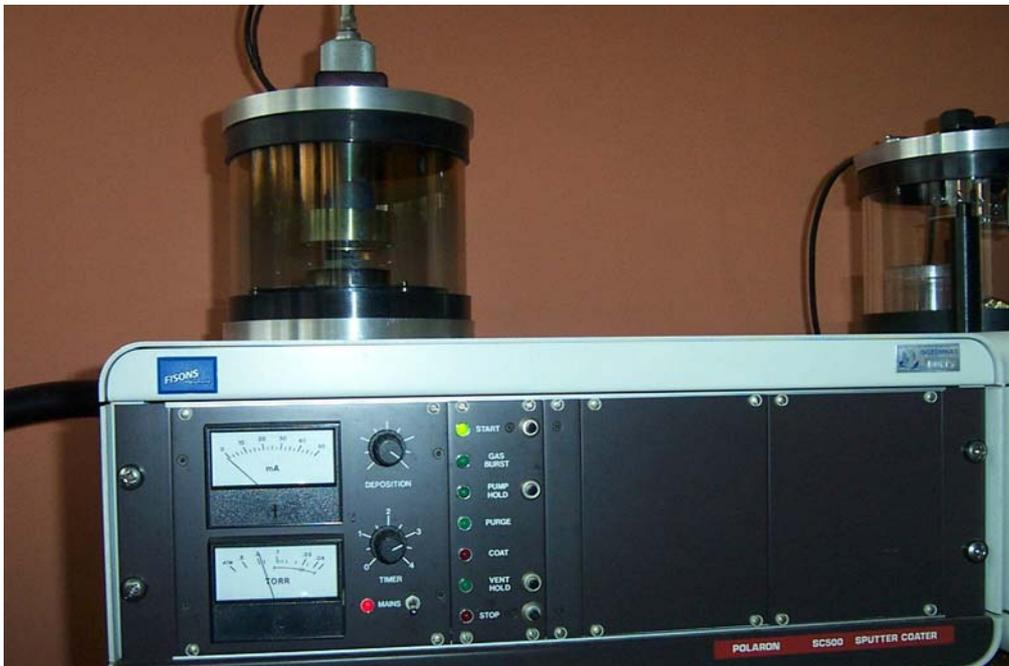
Figura 6.4 Equipo de metalización de muestras para su observación en el microscopio electrónico con alto vacío y detector de electrones retrodispersados.
