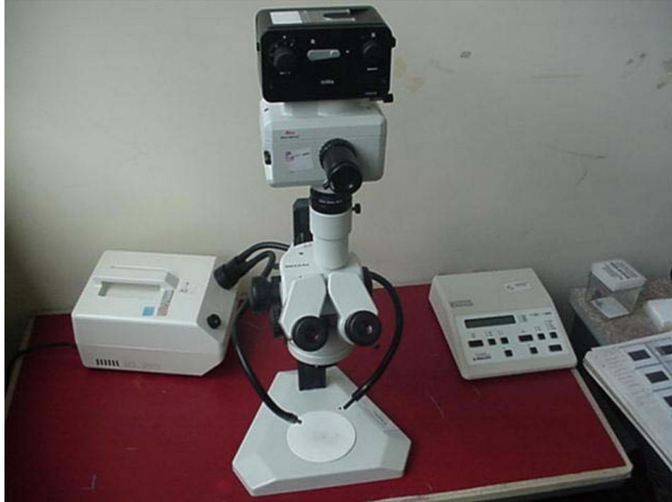
Figura 6.5 Microscopio óptico binocular, dotado de cámara fotográfica en la parte superior. Aumentos entre 6.4X y 48X.
