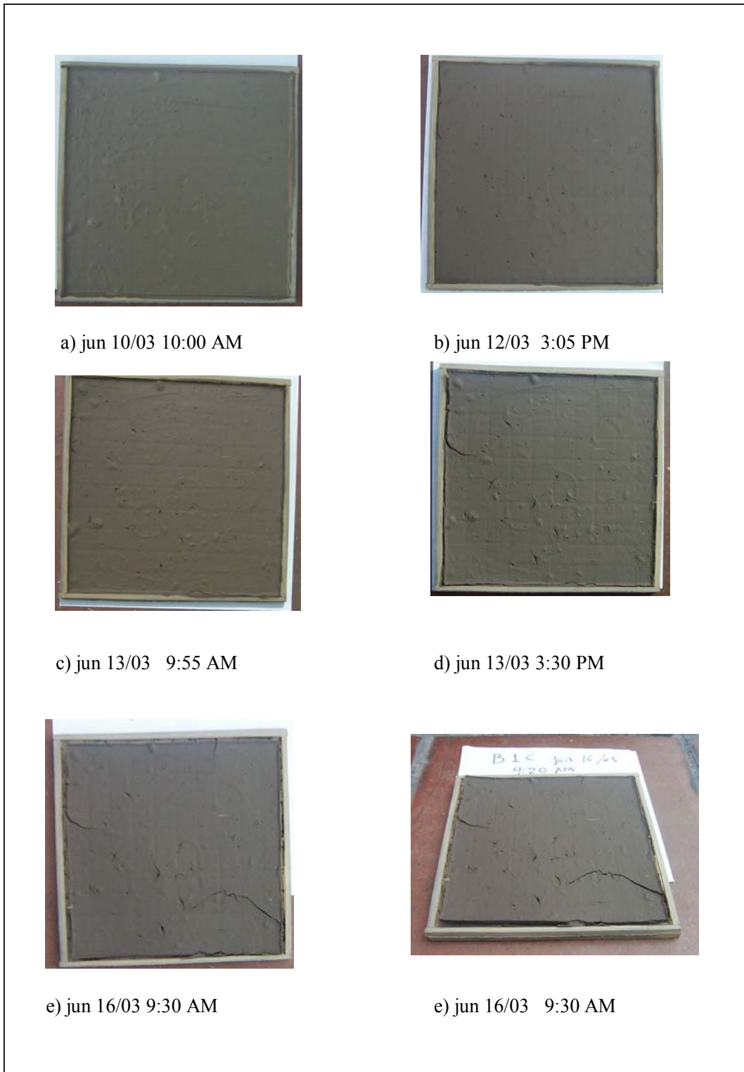
Figura 7.29 Fotografías de la secuencia de agrietamiento en el ensayo B1C.
