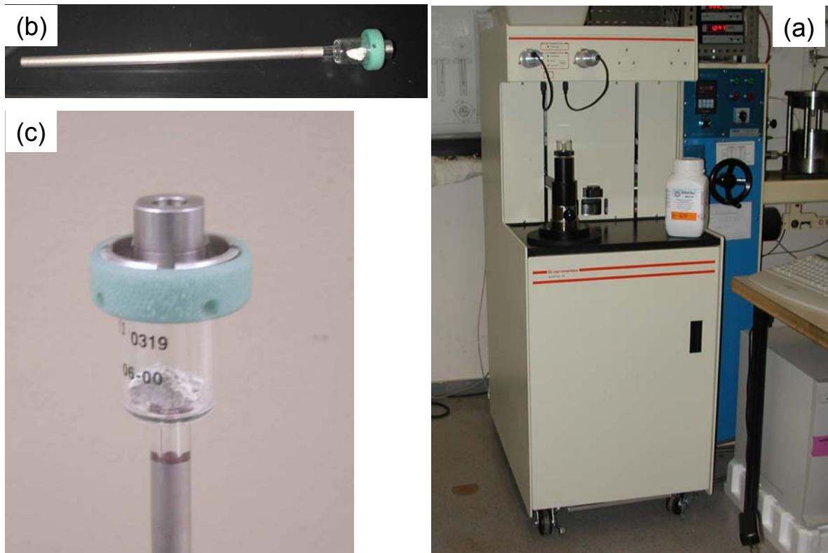
Figura 1.7- Porosimetro de mercurio. a)-Porosimetro Micromeritics AutoPore 9500. b)- Penetrometro. c)- Detalle de muestra de bentonita preparada para ensayo.
