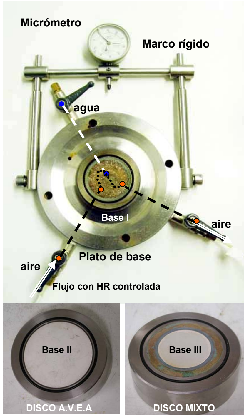
Figura 2.22- Célula edométrica con control de succión. Base apoya muestra, marco rígido y diferentes bases para la aplicación de las distintas técnicas de control de succión
