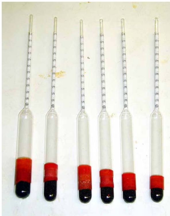
Figura 2.12- Densímetros de flotación utilizados para el control de la concentración de las soluciones de ácido sulfúrico.
