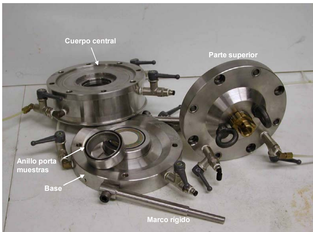
Figura 2.21- Partes de la célula edométrica con control de succión (UPC, 2002).
