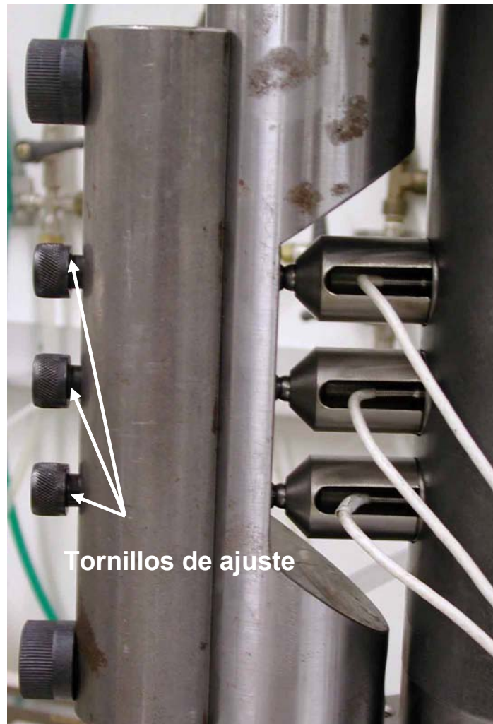
Figura 2.45- Sensores y sistema de fijación.
