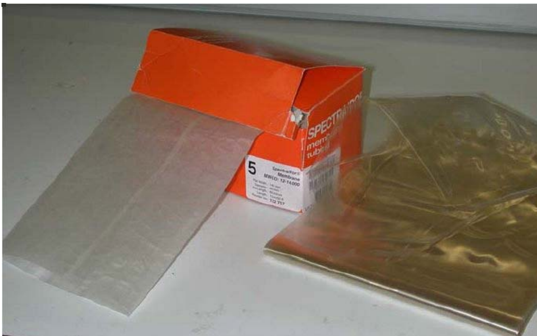
Figura 2.5- Membranas de acetato utilizadas como elemento separador en la técnica de traslación de ejes.
