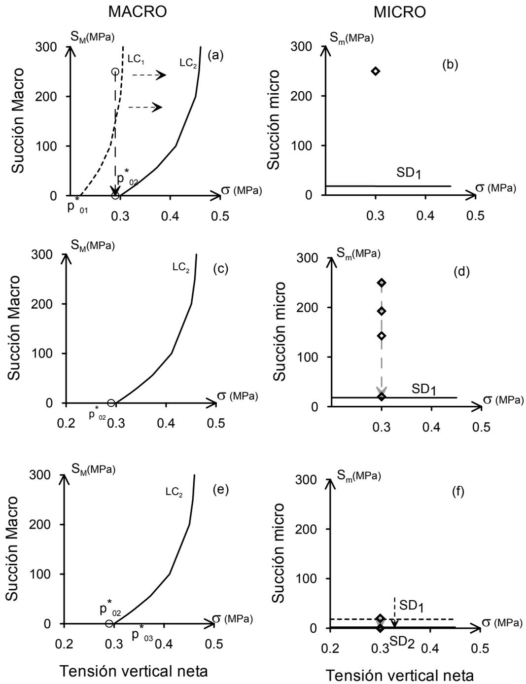
Figura 8.1- Interpretación constitutiva de la evolución de las trayectorias de tensiones a lo largo del ensayo de humedecimiento a carga constante utilizando inundación (transferencia líquida).
