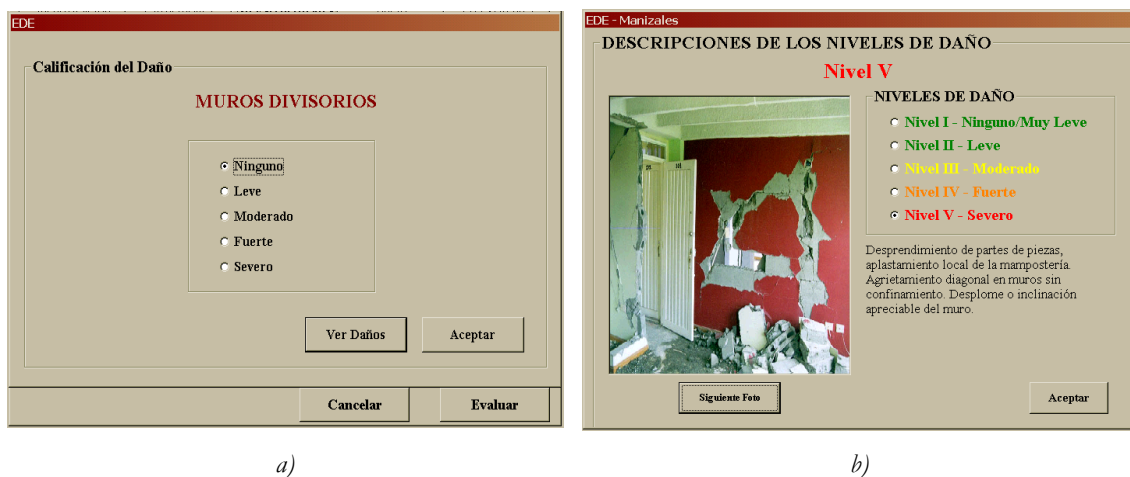
Figura 5.12. Calificación de un elemento no estructural: a) Calificación del nivel de daño; b) Descripciones y fotografías que ayudan a identificar cada nivel
