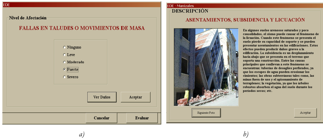
Figura 5.13. a) Calificación de las condiciones del suelo; b) Descripción y fotografías que ayudan a identificar posibles problemas con las condiciones del suelo
