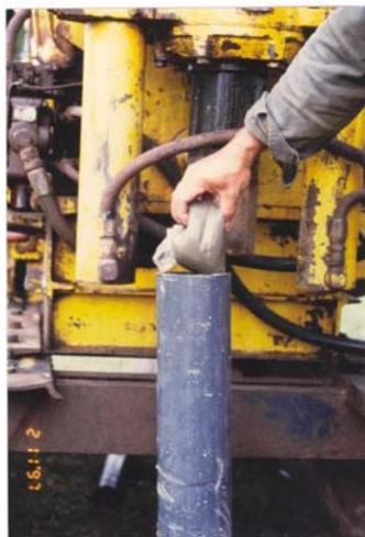
Figura 7.17: Sellamiento del fondo de la excavación
