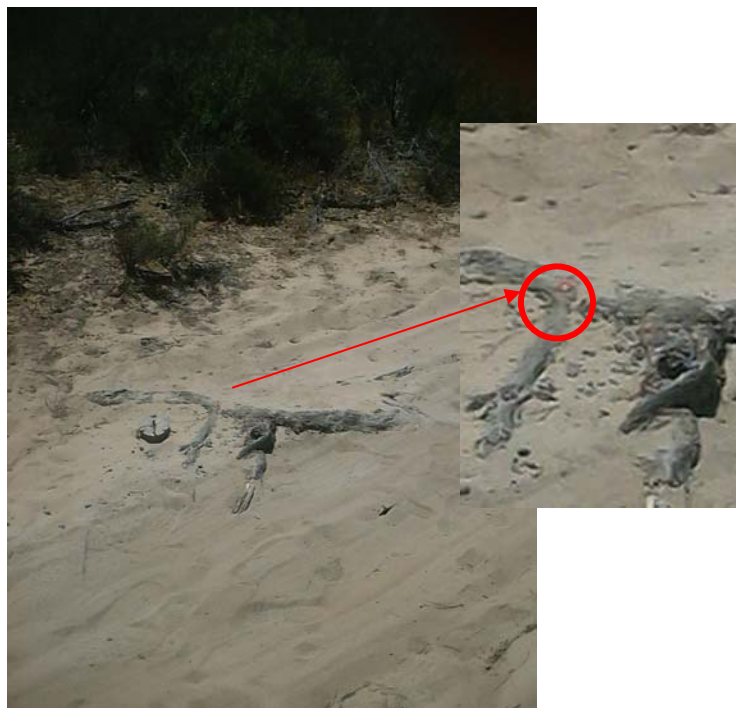
Fig. 6.6. Punto de paso de nivelación materializado con chincheta roja en terreno arenoso (zona de coto, itinerario al punto MOGEA).
