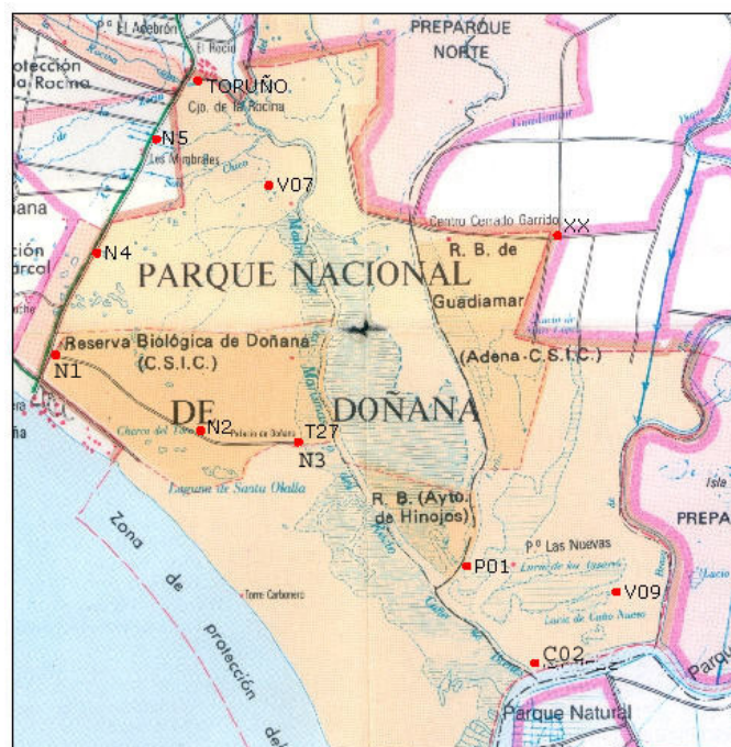
Fig. 5.8. Distribución de los puntos GPS/nivelación/gravedad interiores al Parque, para comprobación de los modelos.
