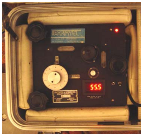
Fig. 6.7. Gravímetro Lacoste&Romberg G1102
