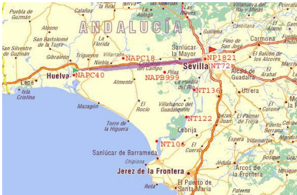
Fig. 5.7. Puntos exteriores pertenecientes a la red N.A.P y red de la J.P.S, seleccionados para el ajuste de los modelos de geoid.
