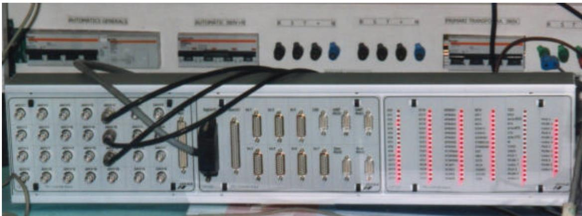
Fig. B.4 La placa de conexión entre la tarjeta dSPACE y circuito de acondicionamiento de las señales y su optoacoplamiento.
