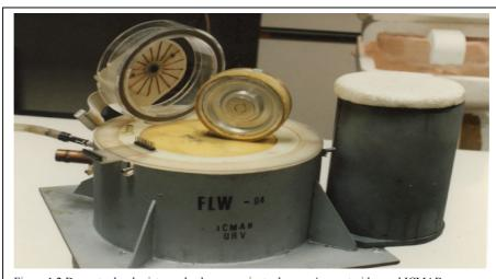
Figura 1.2:Demostrador de sistema de almacenamiento de energía construido en el ICMAB
