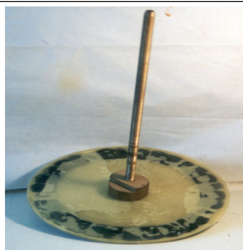
Fig 6.70 Fotografía del rotor construido para el motor de la figura 6.68
