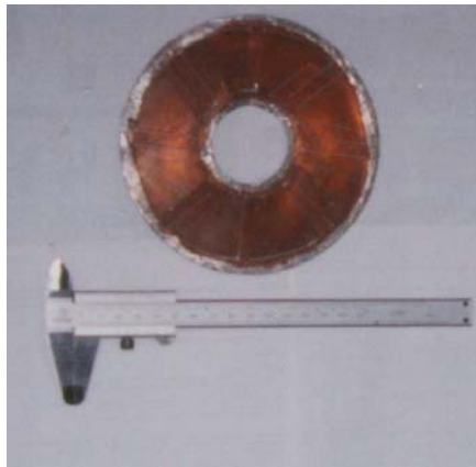
Foto 30: Fotografía del primer plano activo. Se observa los cortes que definen los caminos de corriente.
