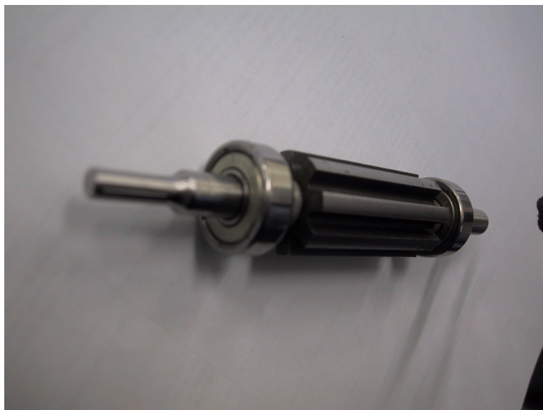
Figura 9.11: Rotor d'un motor de reluctància commutada. S'hi poden veure els pols de rotor
