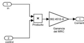
**Fig. 6.26.-** Diagrama de bloques en SIMULINK® de la modelización de una célula MRC utilizada en el filtro con estructura TQE.
