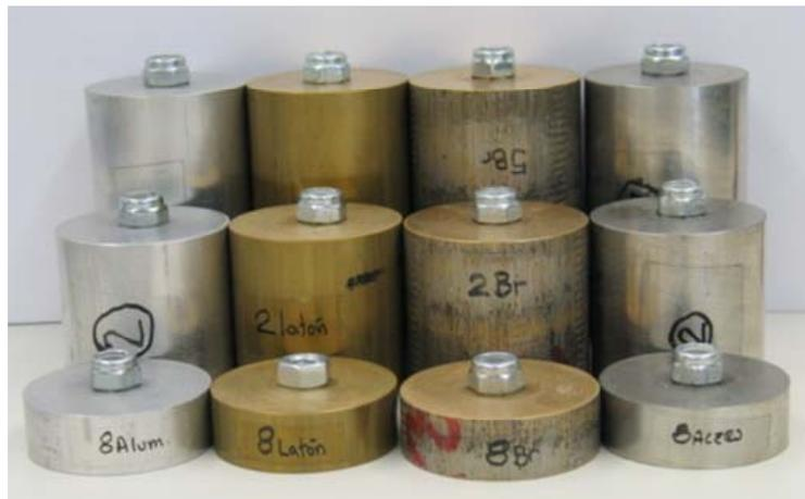
Figura 4-16 Imagen de los cilindros con tuerca.
