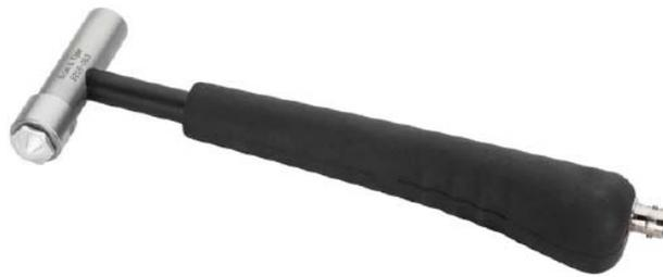
Figura 4-9 Martillo 8206-002 B&K que se utiliza como impactor.
