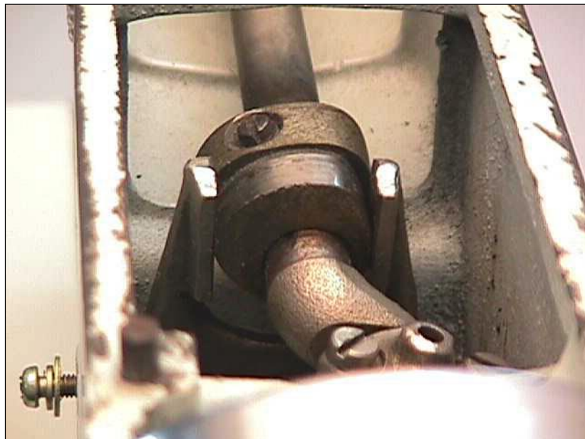
Fig. A-4. Leva de anchura constante utilizada en máquinas de coser
