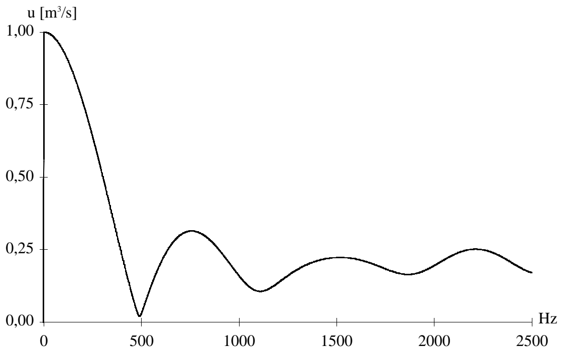
Fig. 1.4.18 Pressió del pavelló de la Fig. 1.4.11 discretitzat en sis trams cònics.
