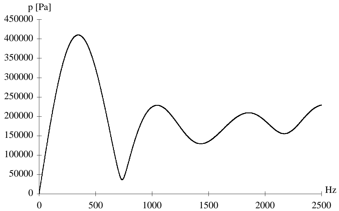
Fig. 1.4.14 Pressió del pavelló de la Fig. 1.4.11 discretitzat en quatre trams exponencials.
