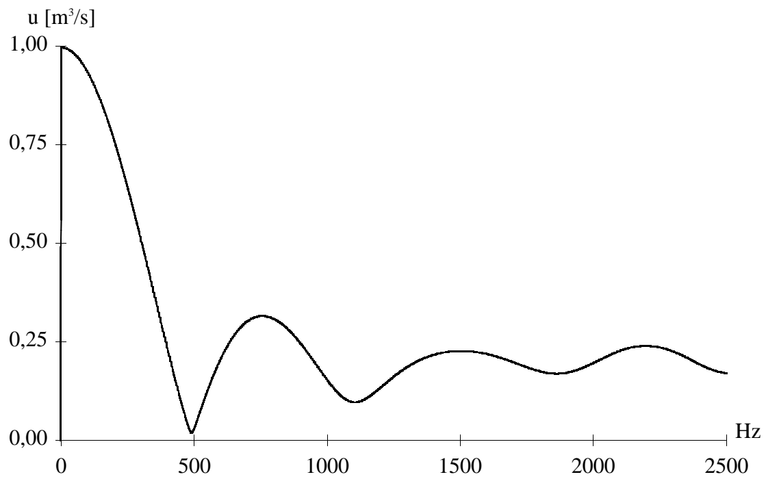
Fig. 1.4.15 Cabal del pavelló de la Fig. 1.4.11 discretitzat en quatre trams exponencials.
