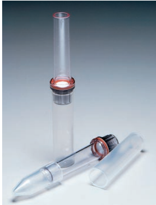
Figura 3.1: Concentrador Centricon (Amion-Millipore) utilitzat durant el procés de concentració de la mostra de proteïna i la de complex de proteïna i DNA.
