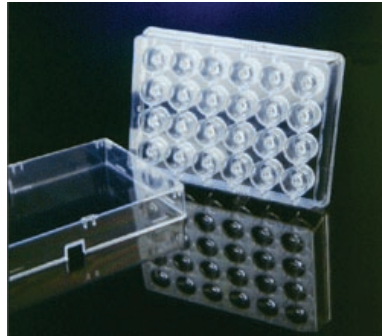
Figura 3.3: Placa de tipus sitting drop de 24 pous utilitzada en els experiments de cristal·lització.
