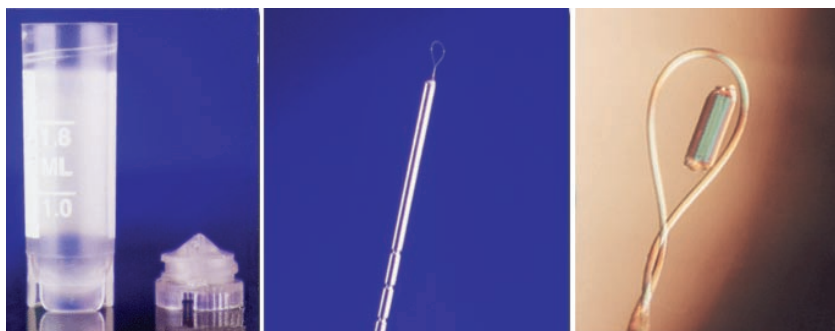
Figura 3.4: Llaç o loop , utilitzat per pescar els cristalls de la gota de cristal·lització, muntat sobre una tija metàl·lica que té un peu imantat. Aquest imant s'utilitza per situar-lo en el goniòmetre de la línia de llum del sincrotró.
