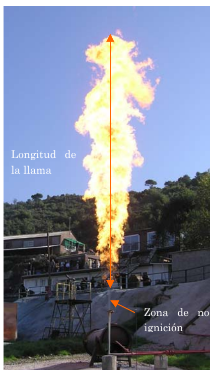
Figura 1.5 Incendio de chorro bifásico (propano)
