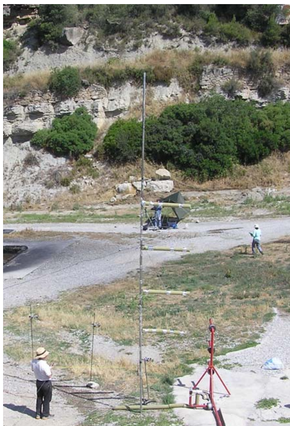
Figura 3.5 Fotografía de los termopares colocados en el mástil. Se puede apreciar el recubrimiento de los cables de compensación y las barras de soporte.
