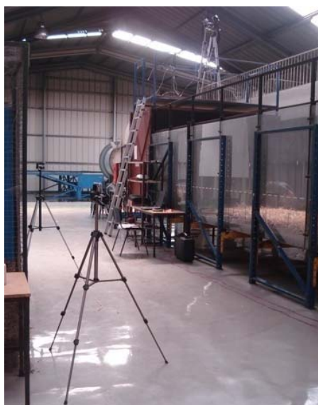
Figura 5.17 Disposició dels equips d'enregistrament d'imatges al túnel de combustió.
