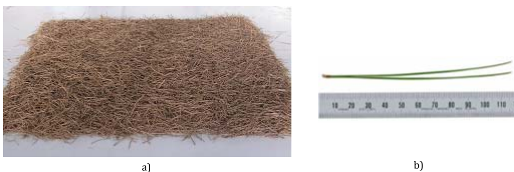
Figura 3.1 Exemple de llit de combustible no natural. a) Imatge d'un llit. b) Detall de les partícules que configuren el llit.
