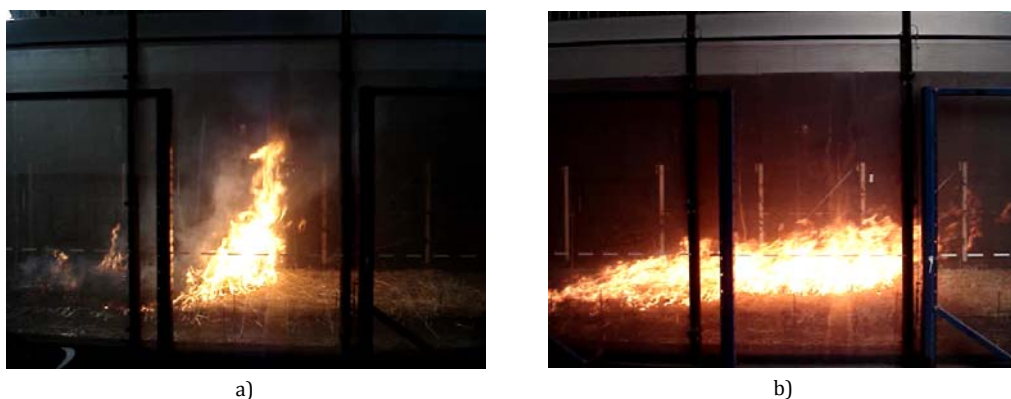
Figura 7.47 Imatges de les proves dutes a terme al túnel de combustió amb llits d'amplada igual a 1.25 m. a) Velocitat del vent igual a 1,1 m/s. b) Velocitat del vent igual a 3,3 m/s.
