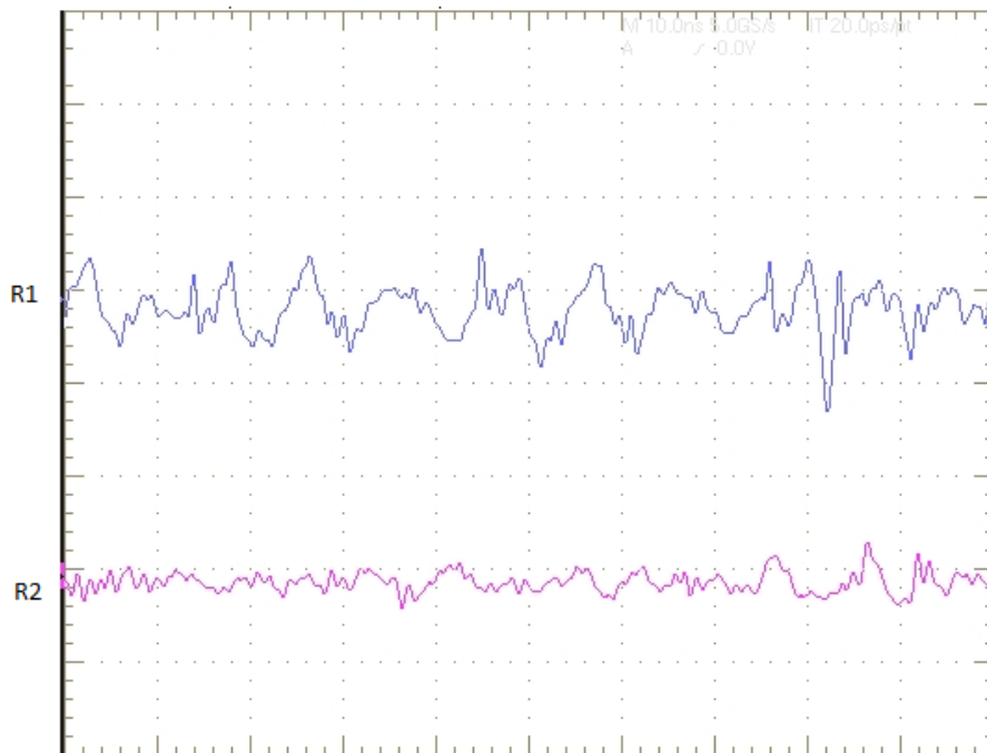
Figura 5.63: Motor funcionando a 4 fases y pulso único, cortocircuito 24 espiras, 1 Nm, 1640 min -1 , R1 aceleración de la vibración 100 m/s 2 /div, R2 ruido acústico 0,2 N/m 2 /div, 2 ms/div.
