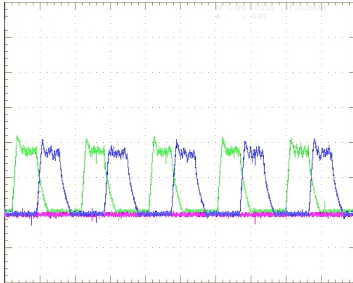
Figura 6.10: Corrientes de fase, Motor 1 funcionando a 2 fases, carga 1.8 Nm, velocidad 750 rpm, 3.8 A/div, 4 s/div.
