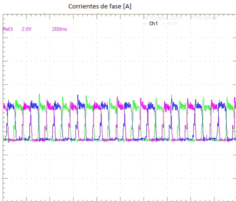
Figura: 5.8: Corrientes de fase antes de la apertura de la fase (funcionamiento a 3 fases), 1.8 Nm, 750 \text{min}^{-1} . (3.8 A/div), 20 ms/div.
