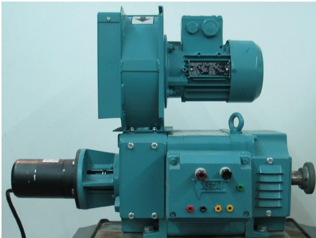
Figura AII.8: Motor de corriente continua utilizado como carga.
