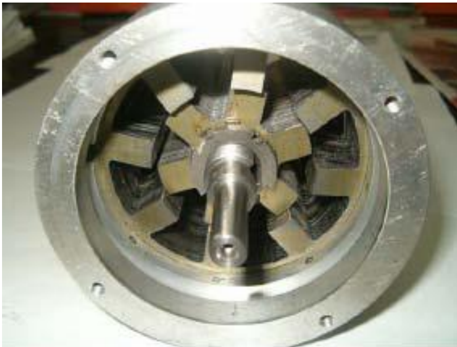
Figura AII.6: Conjunto rotor y estator sin bobinas, SRM 8/6.
