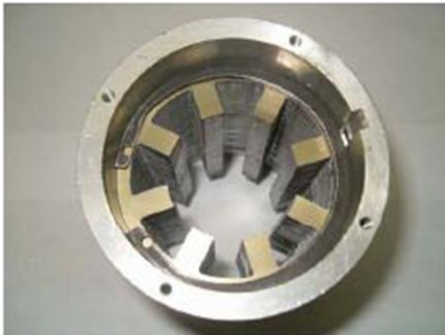
Figura AII.4: Estator sin bobinas, SRM 8/6.
