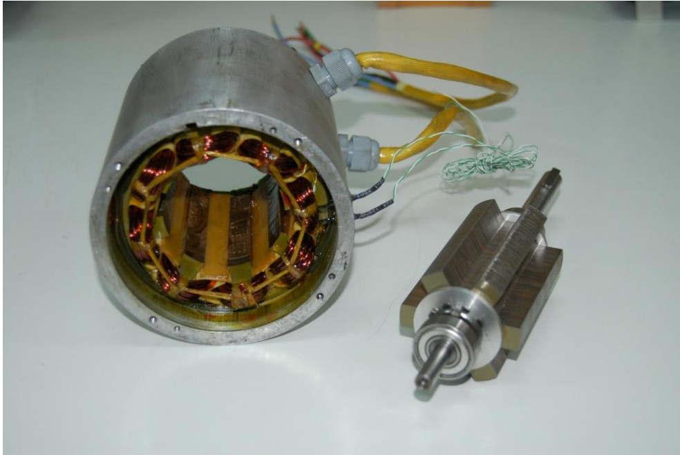
Figura 1.2: Estructura de polos salientes de estator y de rotor de un motor de reluctancia autoconmutado.
