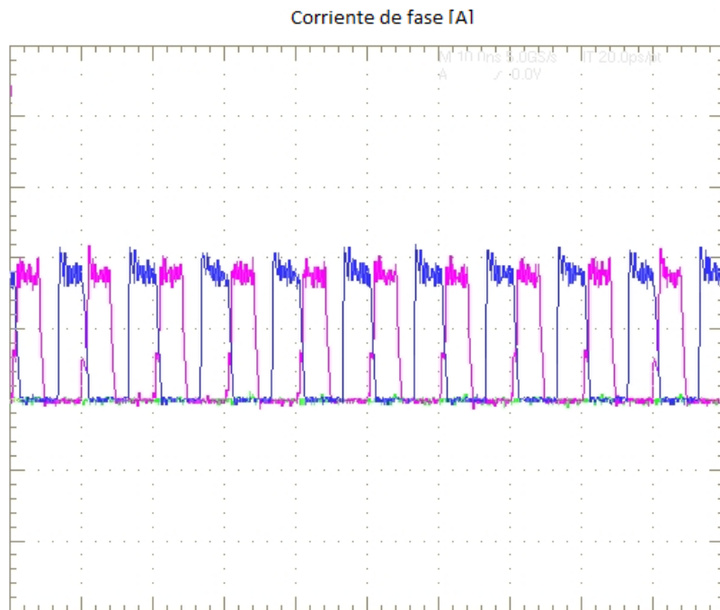
Figura: 5.9: Corrientes de fase después de la apertura de la fase (funcionamiento a 2 fases), 1.8 Nm, 750 min -1 . (3.8 A/div), 20 ms/div.
