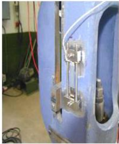
Figure 10 : Posición montaje galgas extensiométricas en yugo
