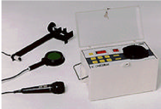
Figura 6.3.3-1 Analizador móvil de niveles de alumbrado lux data Logger LX-1000 [11].
