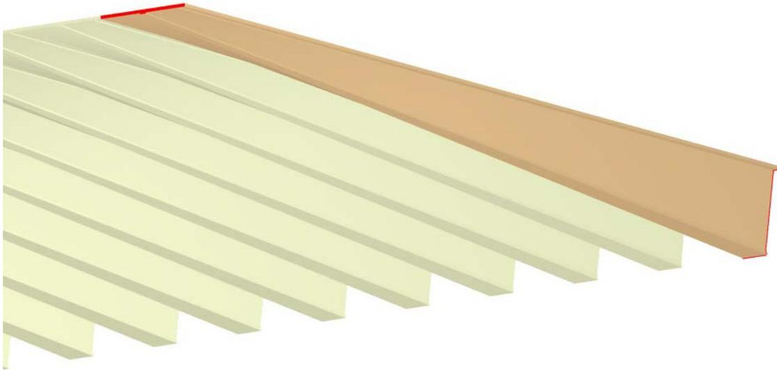
La idea estructural es una lámina plegada con las ondas en zigzag en los apoyos y el perfil rectilíneo en el voladizo.
