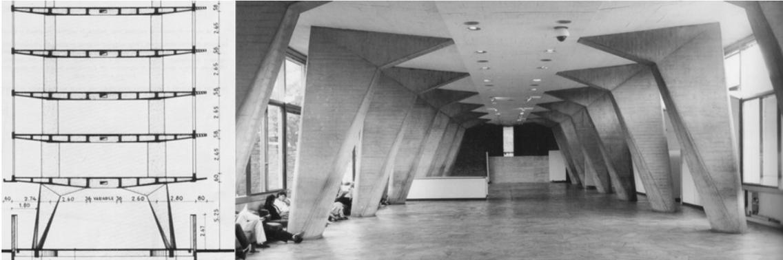
En el pilar de la catedral de New Norcia también ocurre que la dirección de la llegada de la cubierta al capitel no se produce de manera ortogonal, por ser la planta triangular. Esto lleva a diseñar un capitel con una forma poligonal que no se prolonga hasta la basa del pilar, sino que se escoge el círculo para ese extremo inferior, con lo que, a nivel del suelo, la importancia de los ejes de la estructura queda diluida. El pilar se adapta, por tanto, a la geometría de su construcción.
