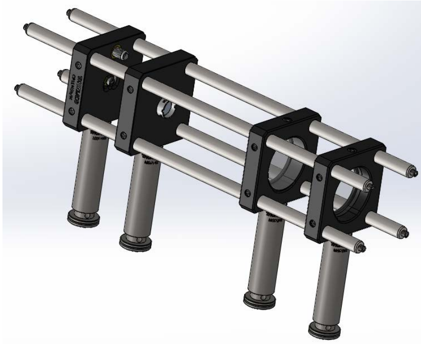
Figura 4.2: Disseny del sistema col·limador-expandidor de feix. Sistema 'Cage Plate' per alinear i fixar tots els elements en un mateix eix òptic. D'esquerra a dreta s'observa: la font de llum, una lent esfèrica, una lent bicòncava i una biconvexa.
