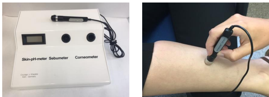
Figura 13. Fotografía del Corneometer CM 825 (izquierda) y fotografía mostrando cómo se realiza una medida con la sonda (derecha).
