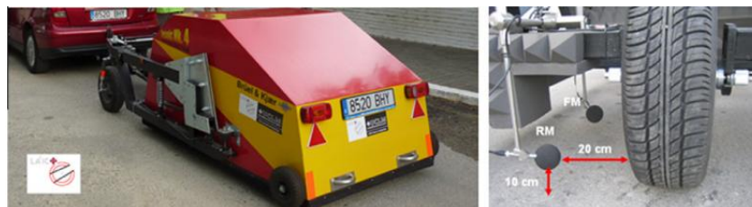
Figura 10 Detalles del equipo de medición del ruido de rodadura de LA2IC-UCLM
