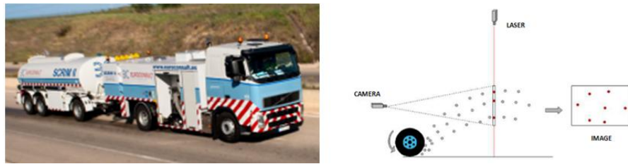
Figura 8 Detalles del equipo de medición del “Splash & Spray” de Euroconsult
