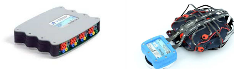
Figura 4. Equips amplificadors. A la dreta l'amplificador sense cable integrat a la mateixa gorra EEG.
