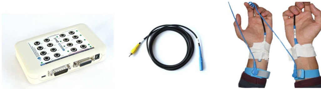
Figura 15. Dispositiu d'estimulació tàtil, vibrotàtil i exemple de col·locació de vibrotàctils en els canell d'un pacient (imatges de g.tec medical engineering GmbH).
