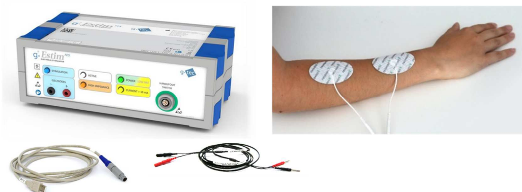
Figura 11. Dispositiu FES amb un exemple d'aplicació al braç d'un pacient (imatges de g.tec medical engineering GmbH).
