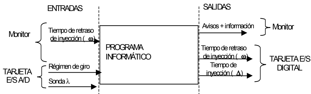
Figura 5.18: Diagrama de entradas/salidas del programa informático.
