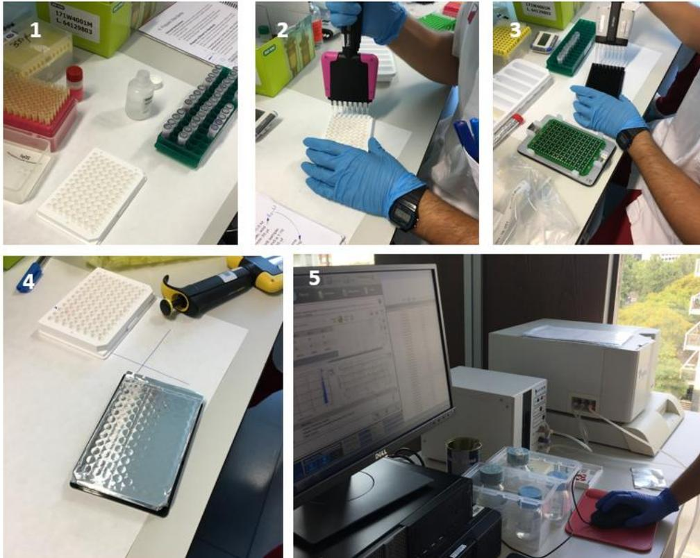
Figura 12: Diversos momentos del procedimiento de análisis de las muestras. 1) Extracción de las muestras de plasma de los criotubos 2) Formación de los complejos enzima-inmunofluorescentes 3) Adhesión de los complejos a la placa de análisis y procedimiento de los diversos lavados necesarios 4) Placa de análisis con 96 celdillas preparada para el análisis 5) Laser citómetro de flujo y procesador digital emisor de los resultados finales.
